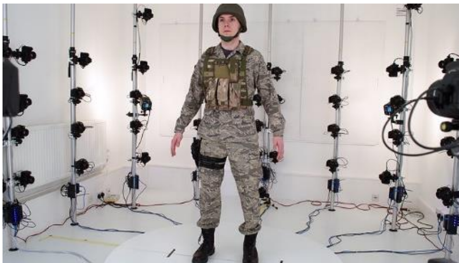
Slika 8. Primjer profesionalnog sustava fotogrametrije
