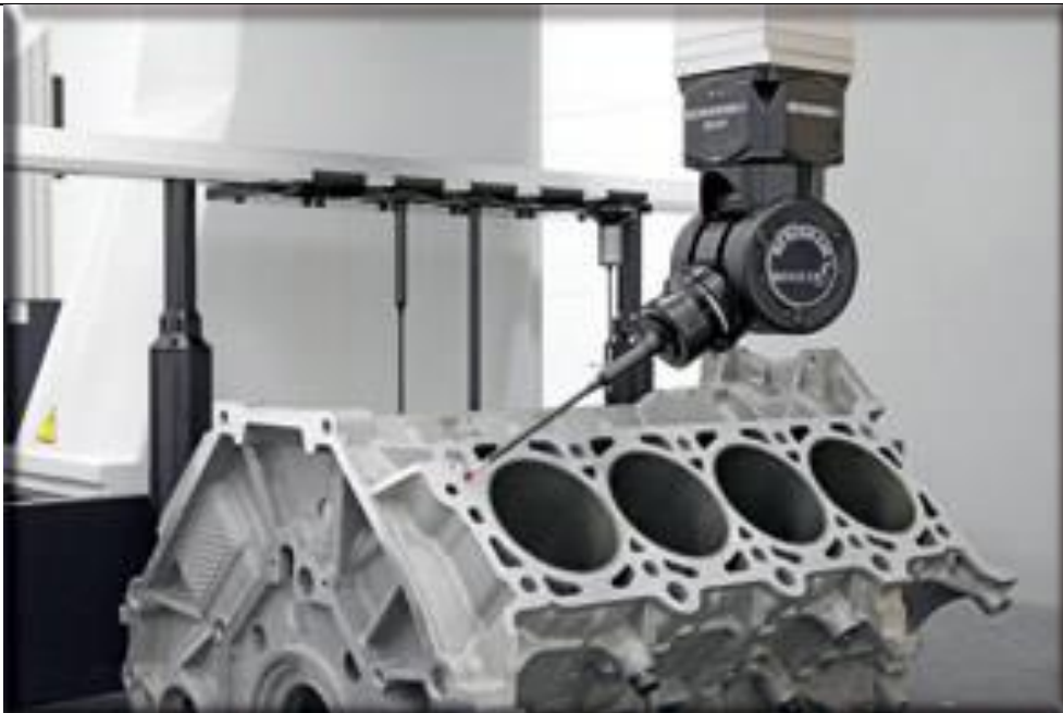
Slika 3. Revvo kontaktni 3D skener
