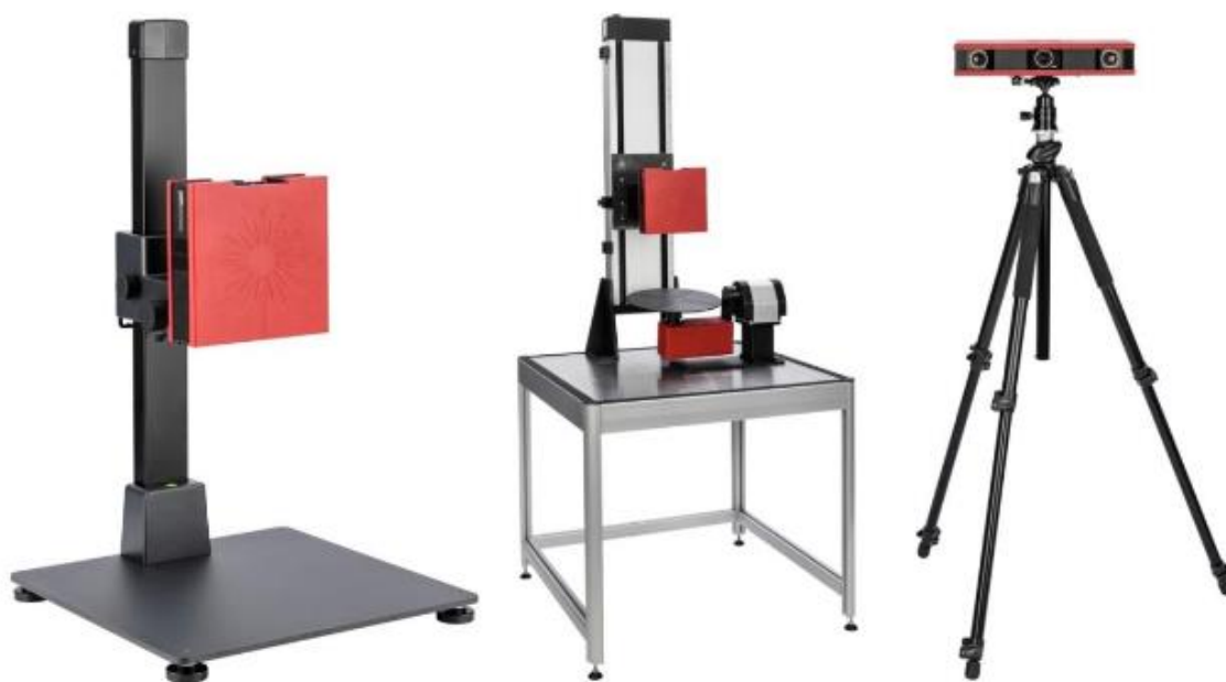
Slika 22. Vrste postave ATOS CORE 3D skenera
