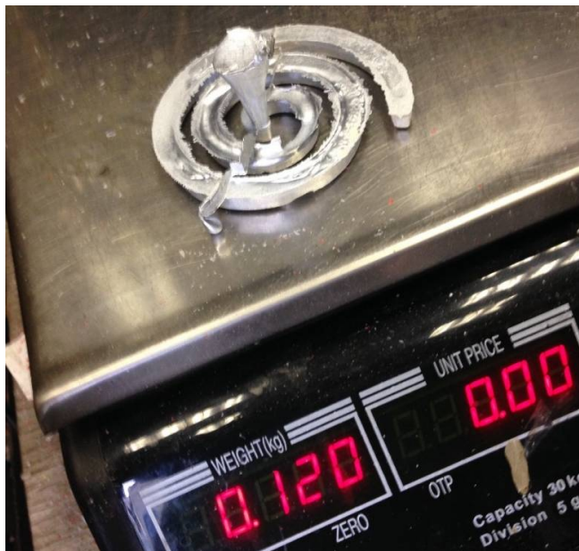
Slika 76. Masa odljevka nakon prvog lijevanja u kalup 3
