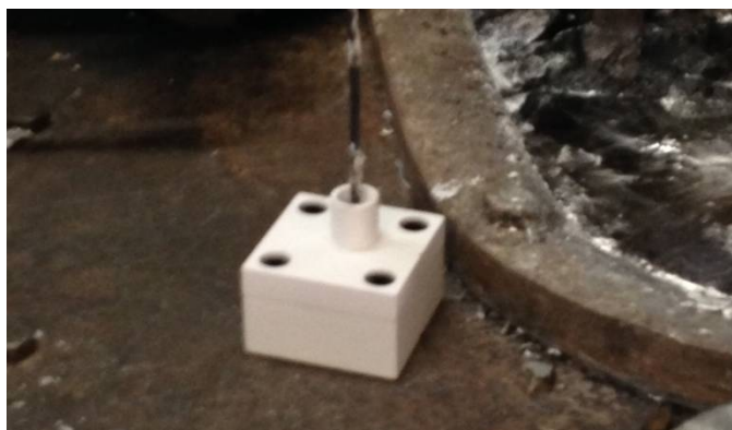
Slika 27. Zagrijavanje kalupa na ljevačkoj peći
