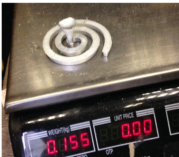
Slika 82. Masa odljevka nakon tećeg lijevanja u kalup 3
