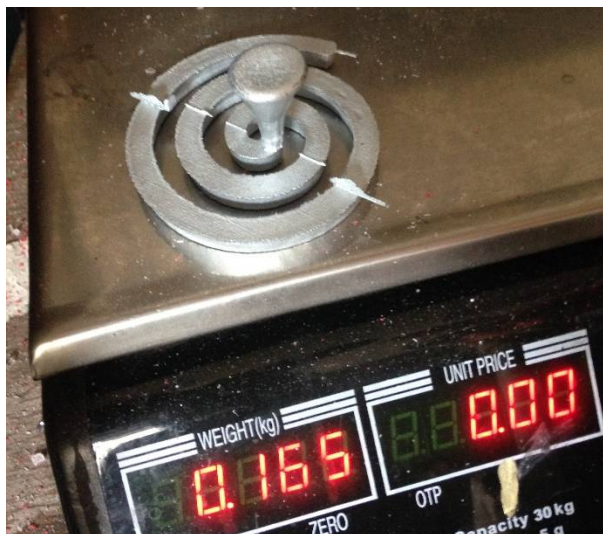
Slika 67. Masa odljevka nakon drugog lijevanja
