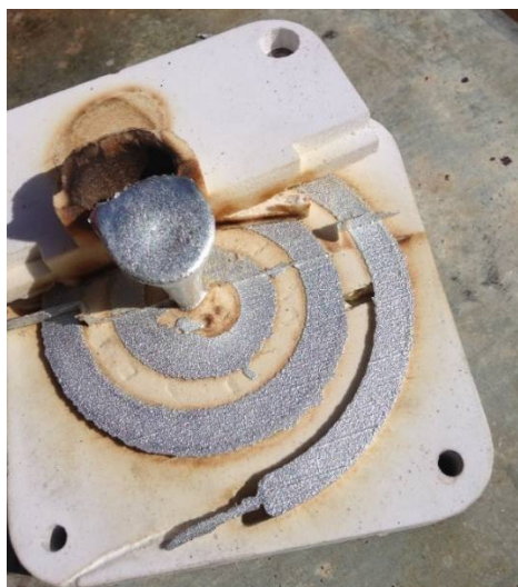
Slika 69. Pucanje Kalupa 2 prilikom vađenja odljevka
