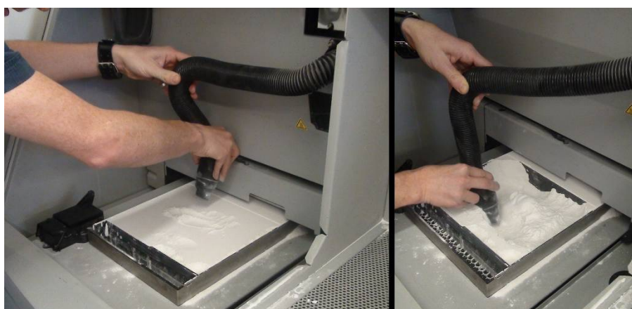
Slika 7. Otklanjanje viška prašine nakon printanja
