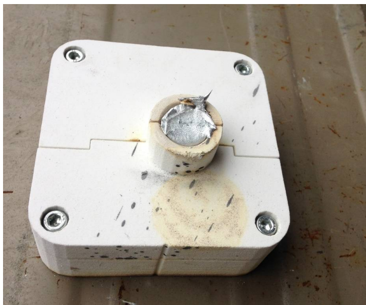
Slika 74. Kalup 3 nakon prvog lijevanja
