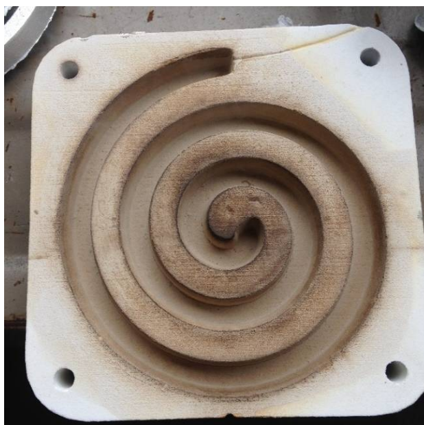
Slika 84. Kalup 3 nakon četvrtog lijevanja
