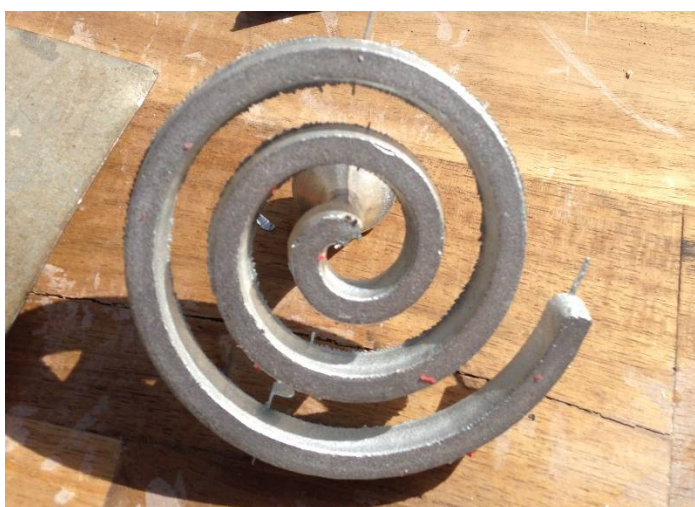
Slika 66. Odljevak nakon drugog lijevanja
