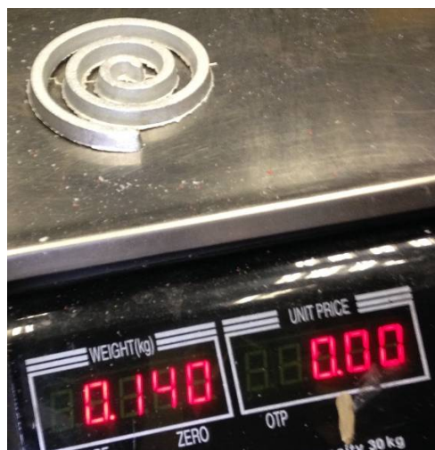
Slika 86. Masa odljevka nakon četvrtog lijevanja u kalup 3
