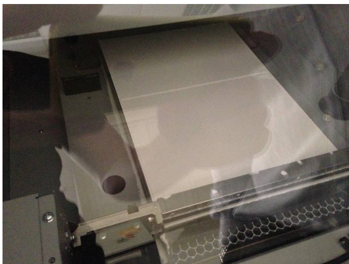
Slika 6. Polaganje praha na tiskovnu platformu
