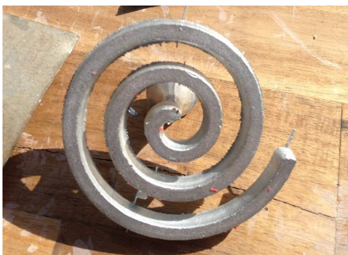
Slika 66. Odljevak nakon drugog lijevanja
