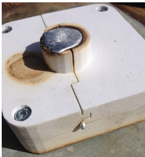
Slika 68. Smanjenje Kalupa 2 nakon trećeg lijevanja
