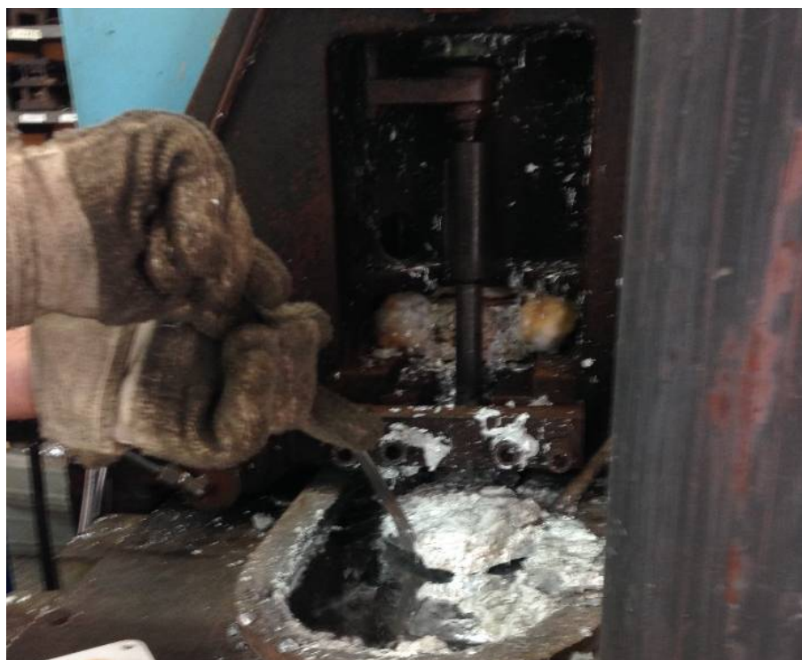
Slika 10. Odstranjivanje oslobođenih oksida sa površine taline
