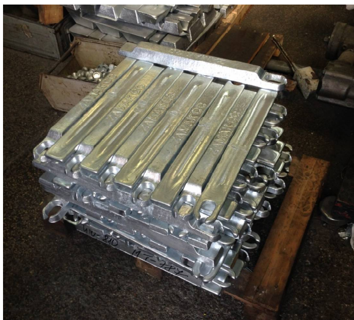
Slika 8. Materijal Zamak 2 ( ZnAl_4Cu_3 )
