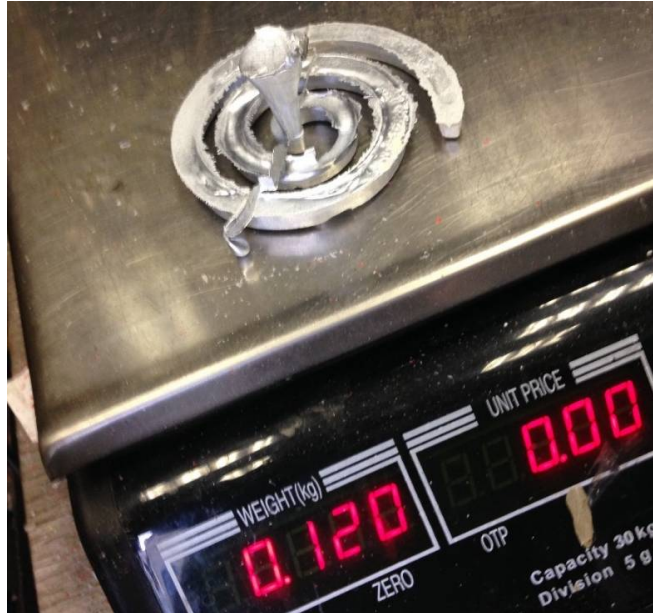
Slika 76. Masa odljevka nakon prvog lijevanja u kalup 3
