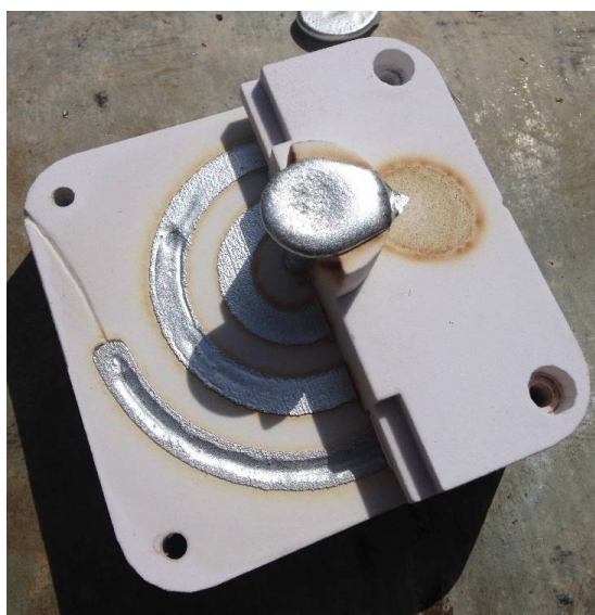
Slika 59. Micanje gornjeg desnog dijela kalupa 2 nakon lijevanja
