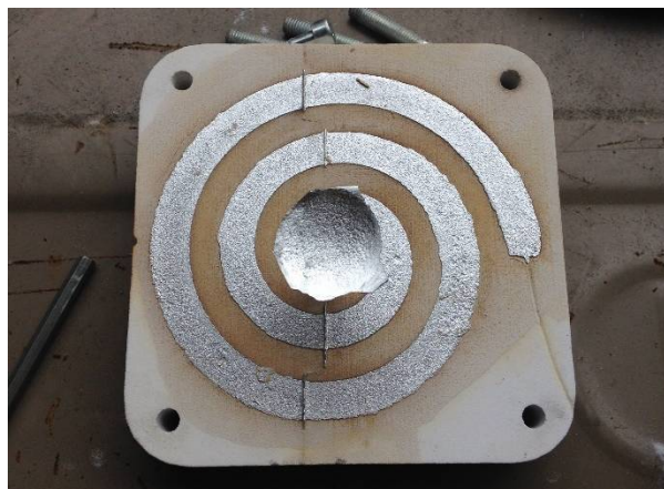
Slika 80. Odljevak nakon trećeg lijevanja u kalup 3
