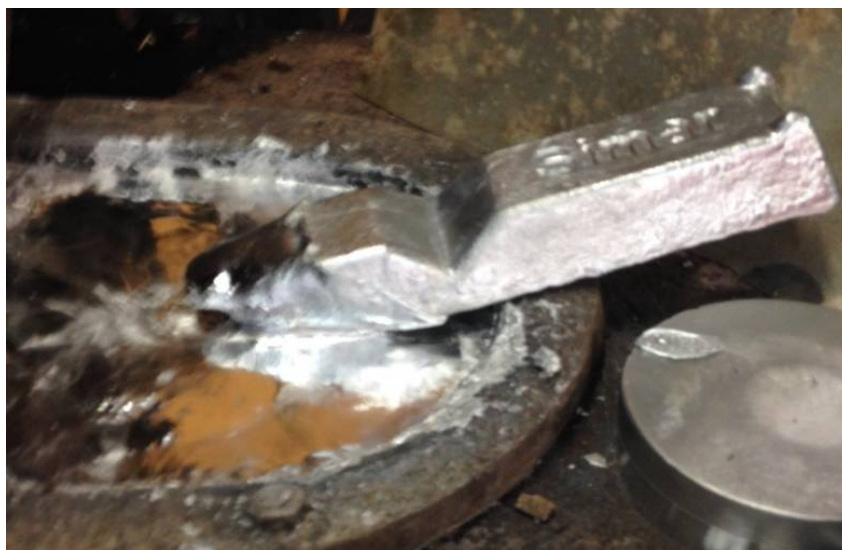
Slika 9. Taljenje legure Zamak 2 ( ZnAl_4Cu_3 )
