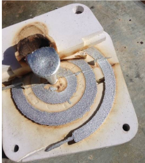
Slika 69. Pucanje Kalupa 2 prilikom vađenja odljevka
