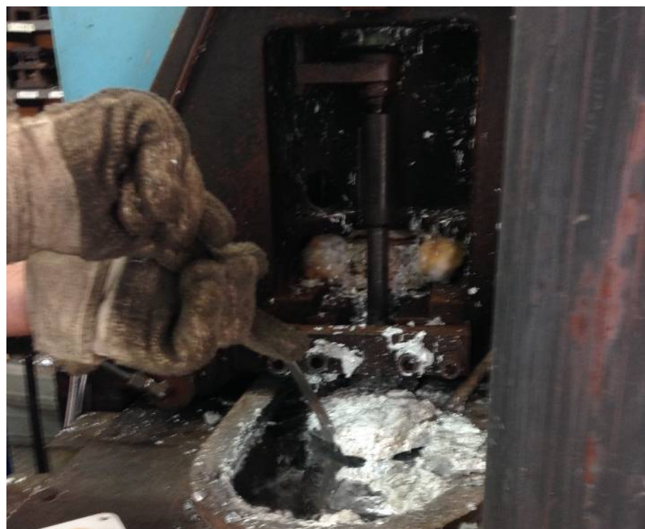
Slika 10. Odstranjivanje oslobođenih oksida sa površine taline
