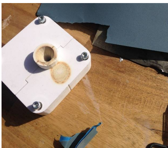
Slika 63. Brušenje i sklapanja kalupa 2 prije početka drugog lijevanja
