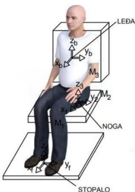
Slika 1. Smjer djelovanja vibracija ovisno o dodirnoj točki
