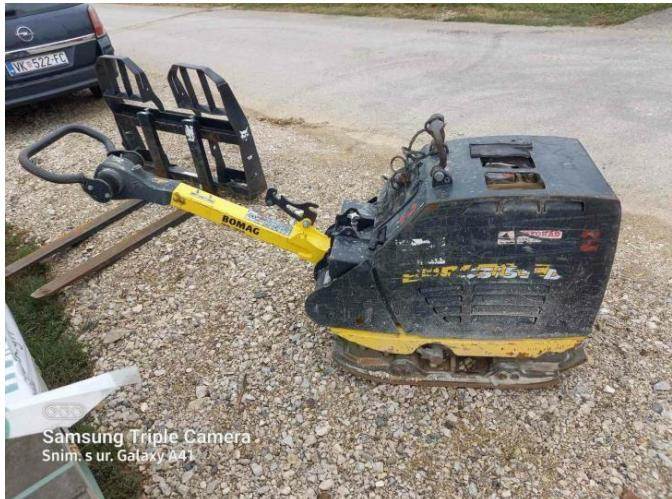
Slika 17. Vibracijska ploča „BOMAG“
