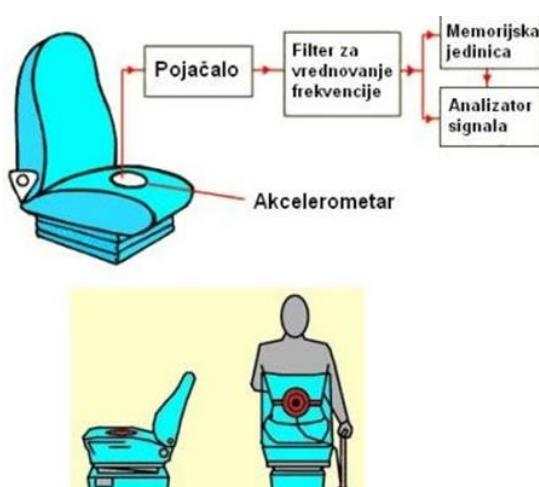
Slika 13. Prikaz postavljanja akcelerometra i njegovi dijelovi
