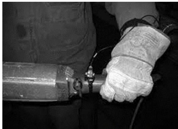
Slika 10. Prikaz mjerjenja vibracija sustava ruka-šaka
