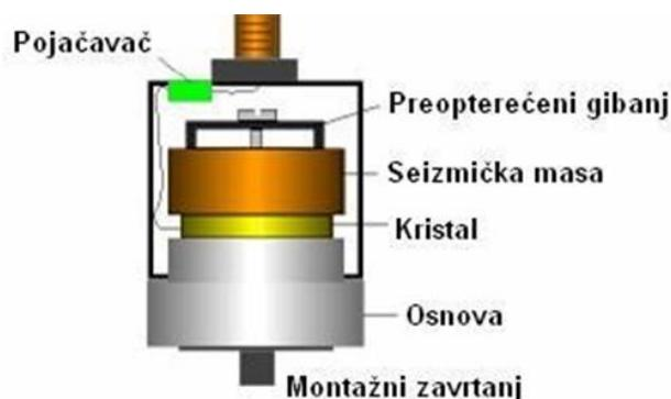
Slika 9. Dijelovi akcelerometra
