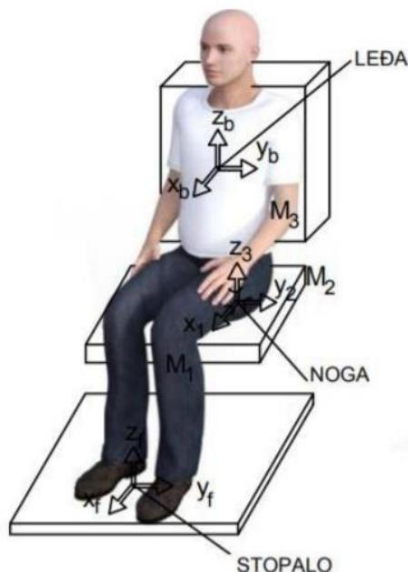
Slika 1. Smjer djelovanja vibracija ovisno o dodirnoj točki
