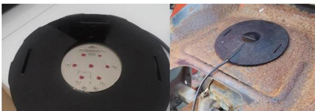
Slika 12. Prikaz akcelerometra koji mjeri u tri osi
