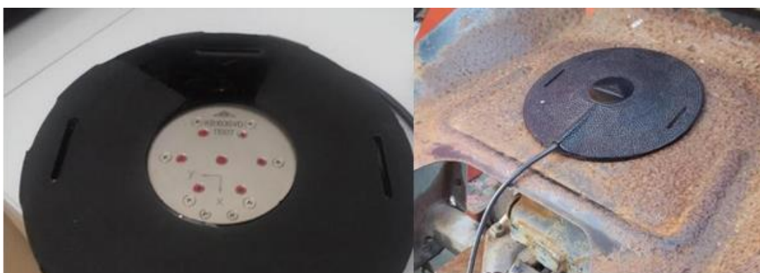
Slika 12. Prikaz akcelerometra koji mjeri u tri osi
