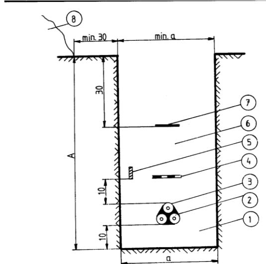
*Slika 9. Kabelski kanal, polaganje kabela u trokut [13]*
