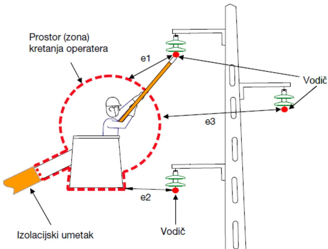
Slika 23. Rad „na udaljenosti“ iz autoplatorme na SN vodu [18]
