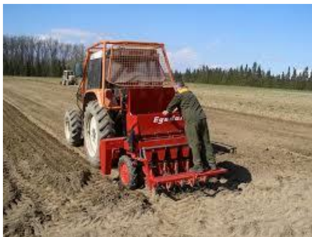
Slika 4: Traktor sa sitrilicom
