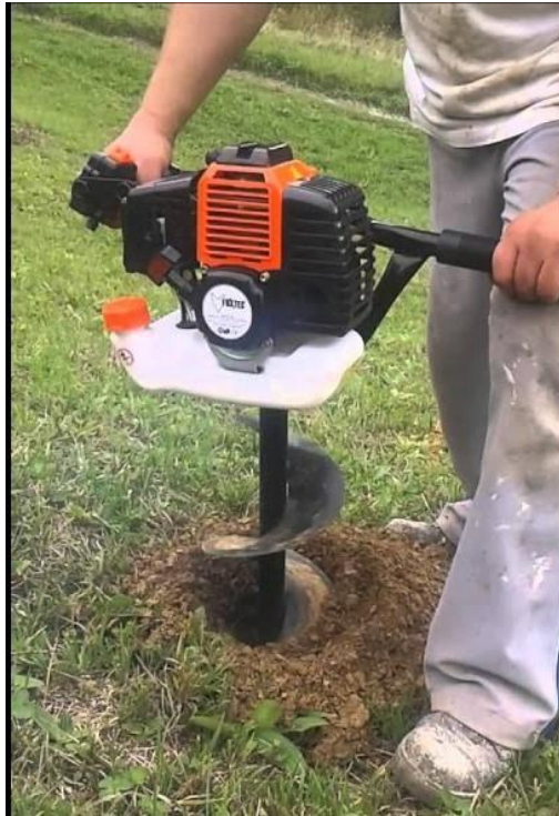
Slika 8: Bušenje rupa strojno
