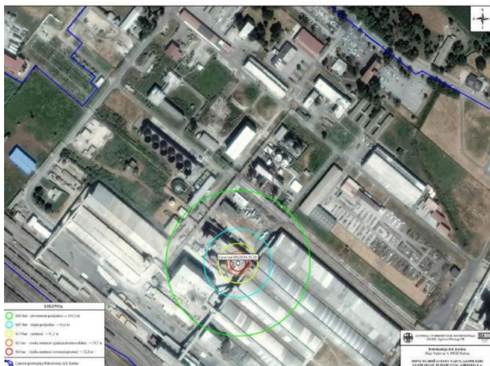
Slika 11. Zone ugrožavanja nadtlakom kod eksplozije plinovitog amonijaka [15]
