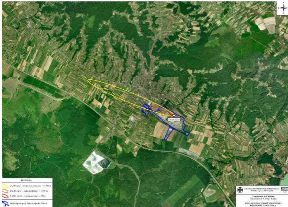
Slika 8. Zone ugrožavanja toksičnim emisijama [15]
