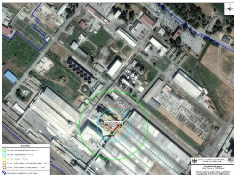
Slika 11. Zone ugrožavanja nadtlakom kod eksplozije plinovitog amonijaka [15]
