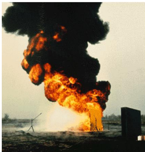
Slika 24. Deflagracija ili sagorijevanje [4]
