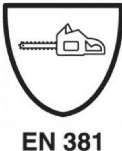
Slika 15: Piktogram odjeće koji osigurava zaštitu od motorne lančane pile
