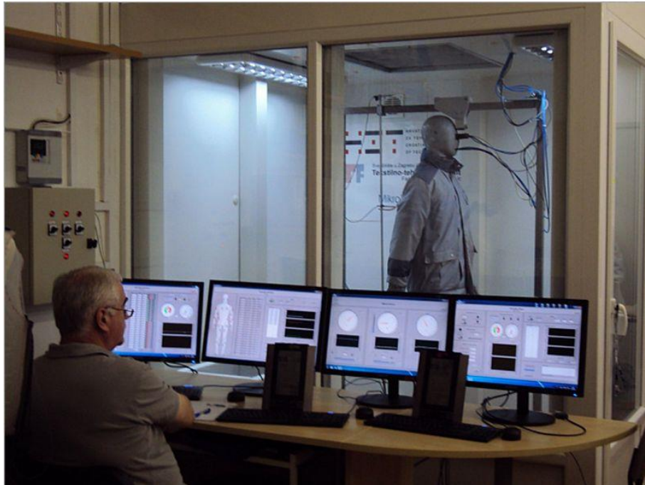
Slika 31: Termalni maneken s Tekstilno-tehnološkog fakulteta u Zagrebu
