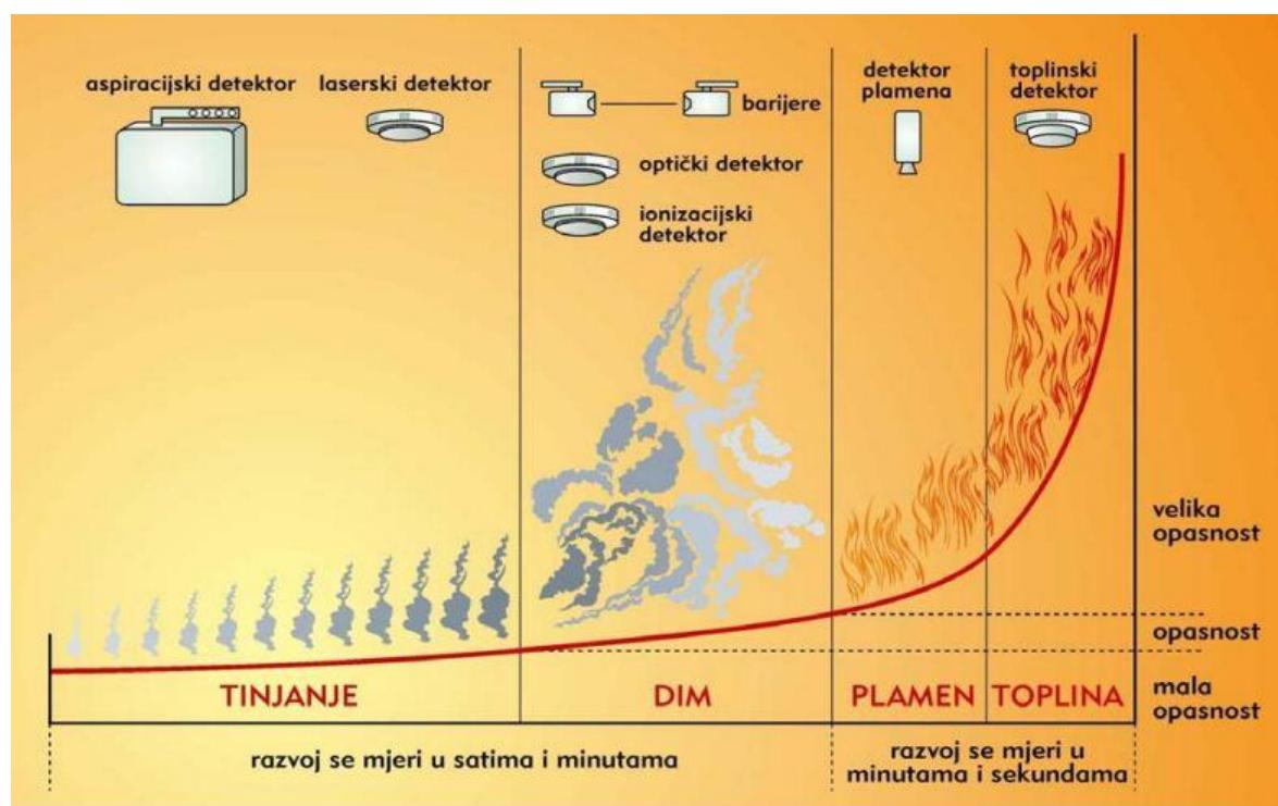
Slika 13: Detektori požara po fazama razvoja požara
