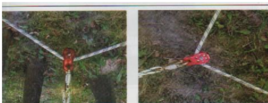
Slika 22. Primjer postavljanja devijatora [6]
