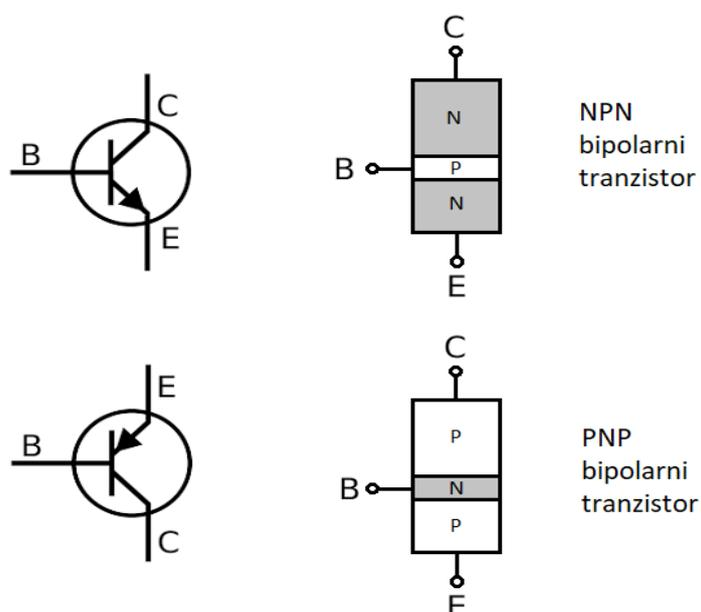
Slika 2. Predodžba bipolarnog NPN i PNP tranzistora
