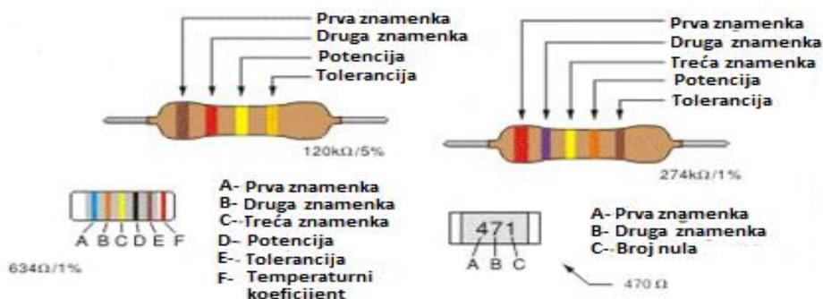
Slika 7. Predodžba očitavanja vrijednosti otpora pomoću boje
