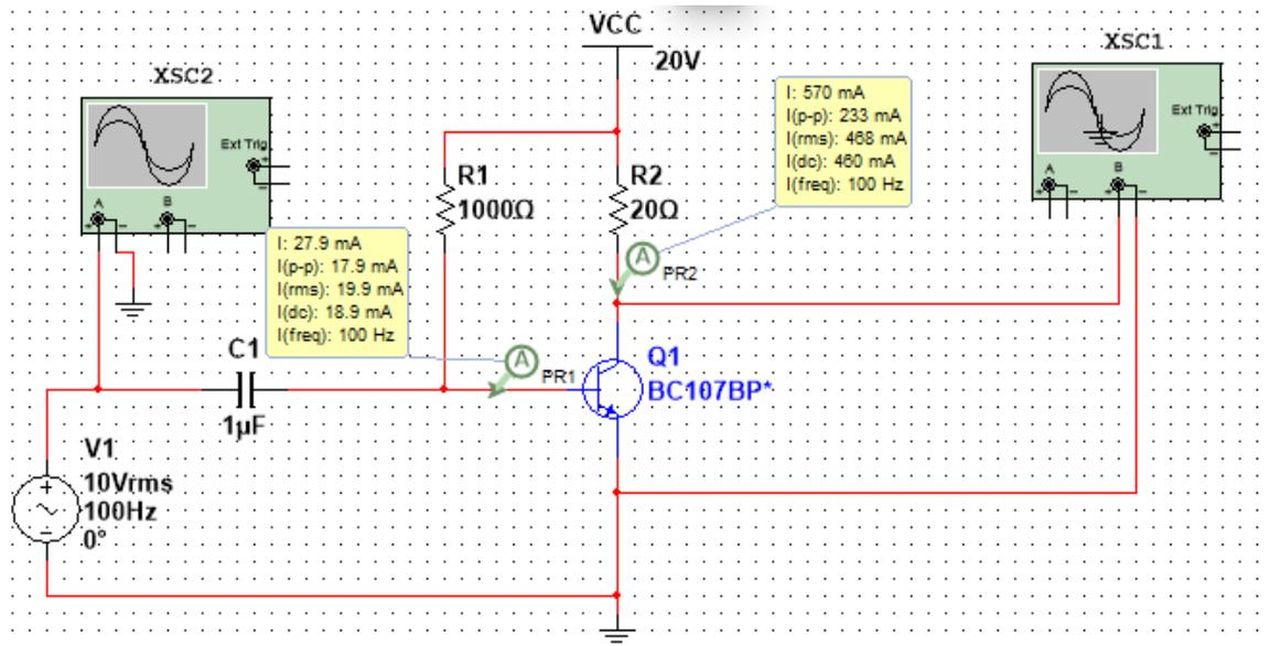
Slika 18. Predodžba sheme sa izmjerenim efektivnim vrijednostima struja
