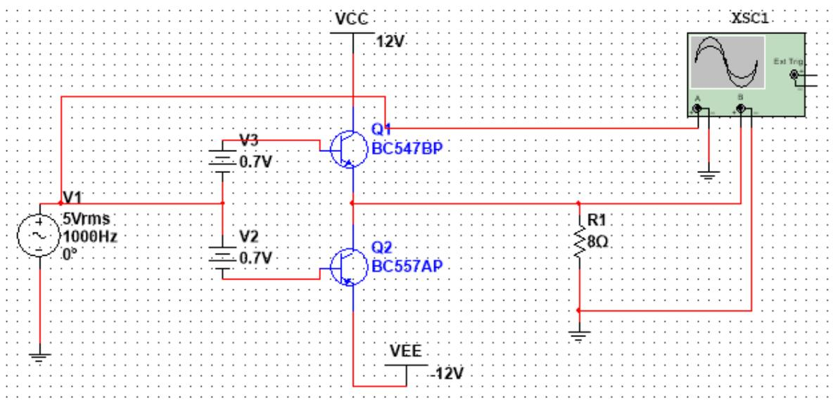
Slika 30. Predodžba iz softvera - Shema pojačala s istosmjernim izvorima u bazi
