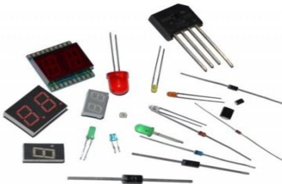
Slika 6. Predodžba različitih tipova dioda
