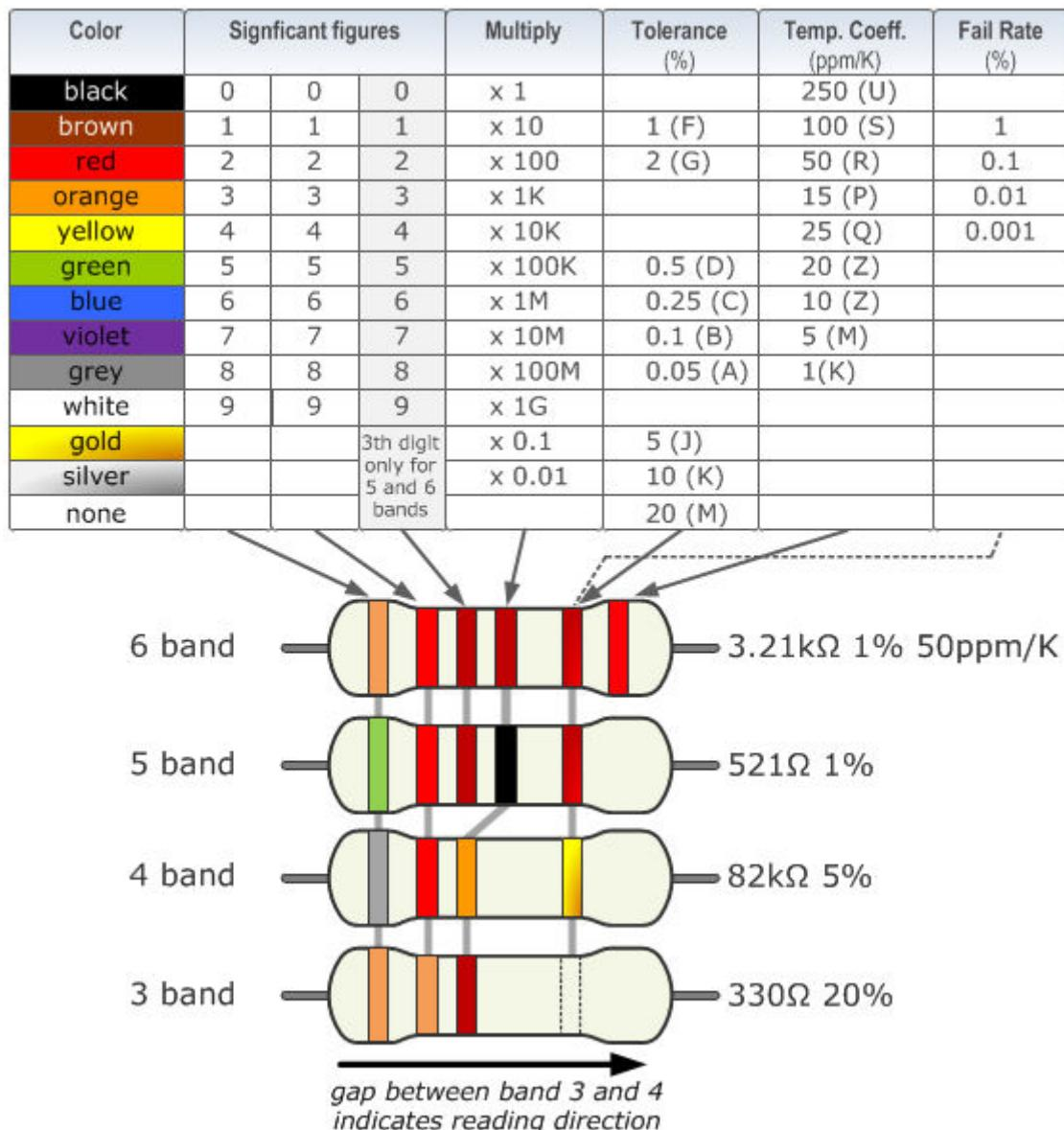
Slika 17: Očitavanje vrijednosti otpornika [18]
