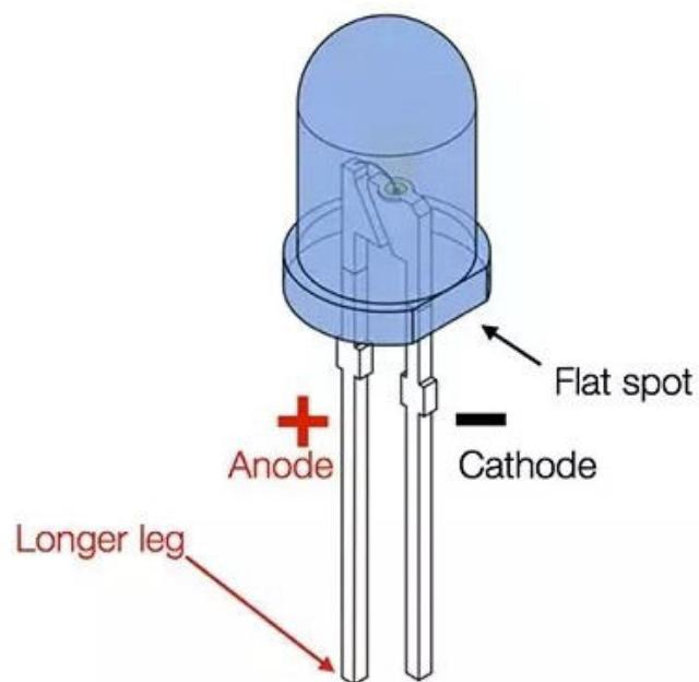
Slika 20: Svjetlosna dioda [23]
