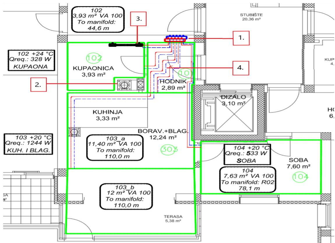
Slika 9. Tlocrt stana s predviđenim ključnim uređajima za postavljanje podnog grijanja
