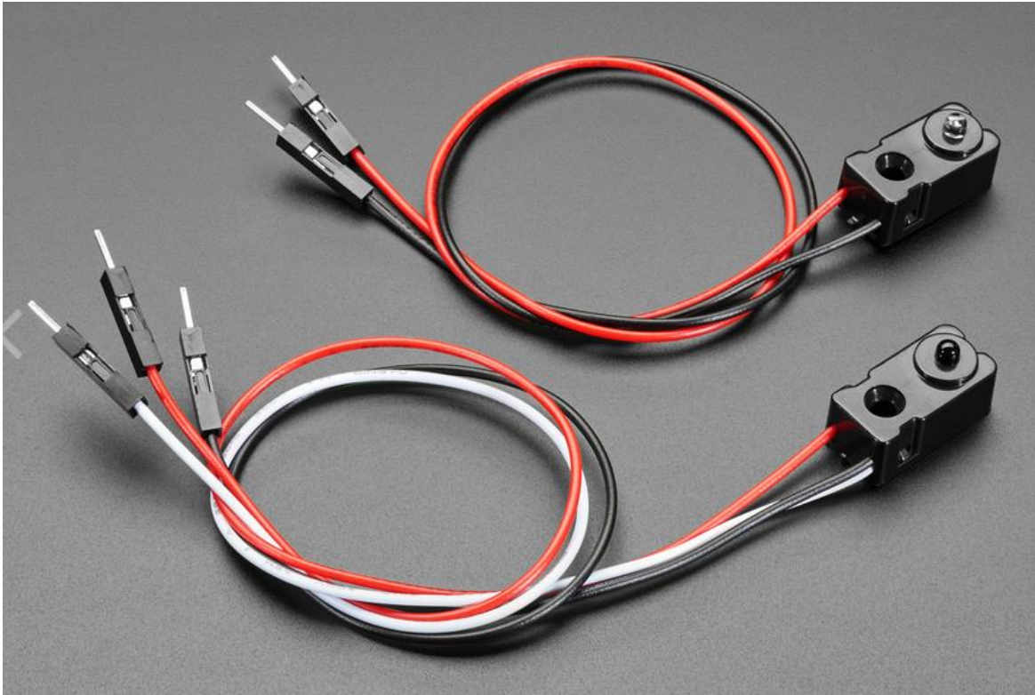
Slika 42. IR Break Beam senzor [19]
