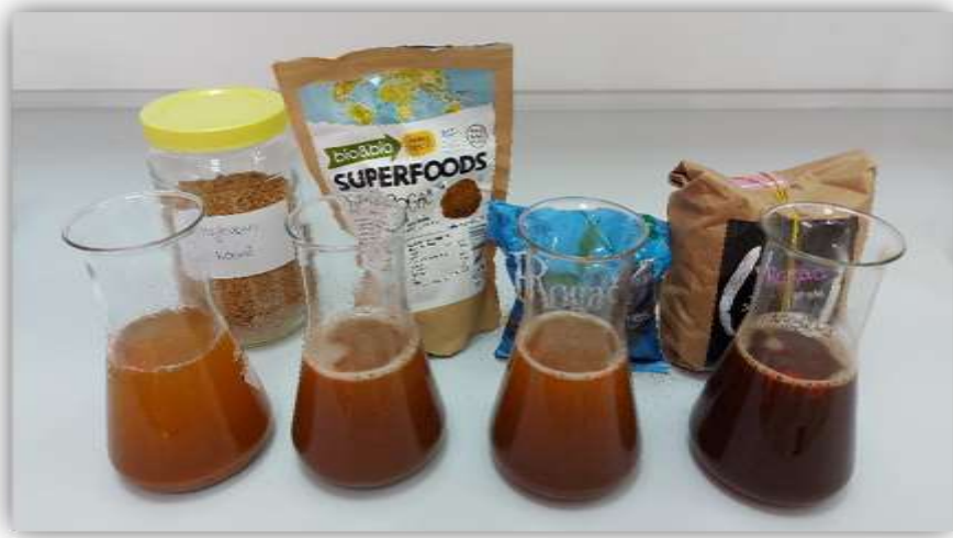
Slika 6. Otopine rogača sa etanolom (Izvor: vlastita fotografija)
