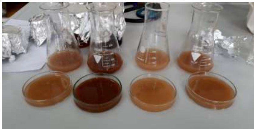
Slika 8. Izlijevanje otopina pektina sa rogačem u Petrijeve zdjelice (Izvor: vlastita fotografija)
