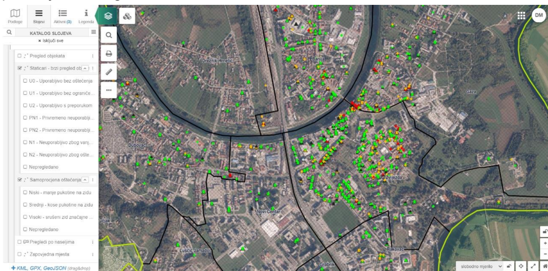
Slika 27 GIS prikaz objekata oštećenih u potresu – Karlovac[36]
