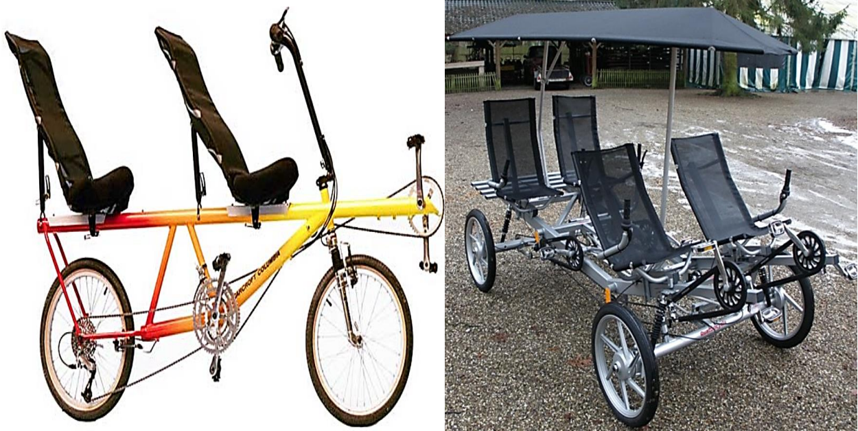
Slika 31. Tandemski ležeći bicikl i četverosjedni četverocikl s tendom za zaštitu od sunca [15]
