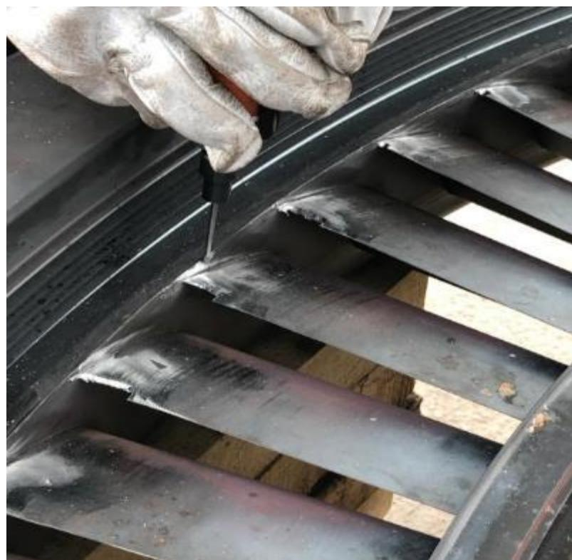
Slika 27. Izrezivanje oštećenih dijelova
