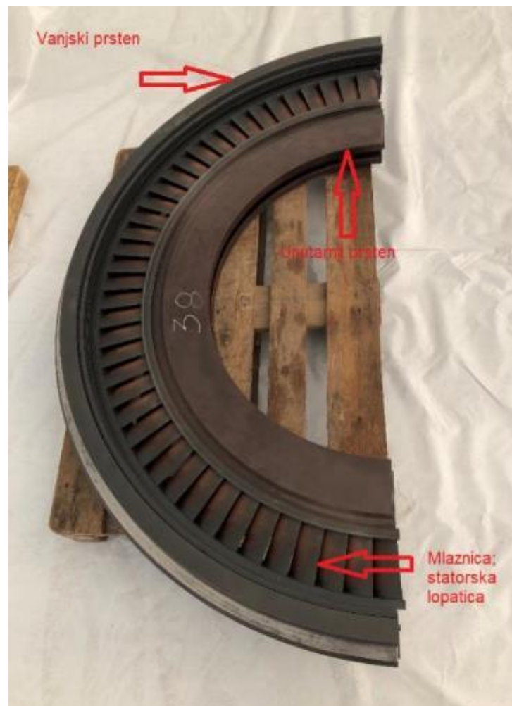
Slika 7. Osnovni dijelovi dijafragme
