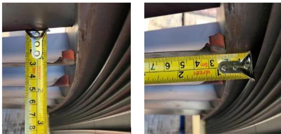
Slika 21. Utvrđivanje veličine oštećenja
