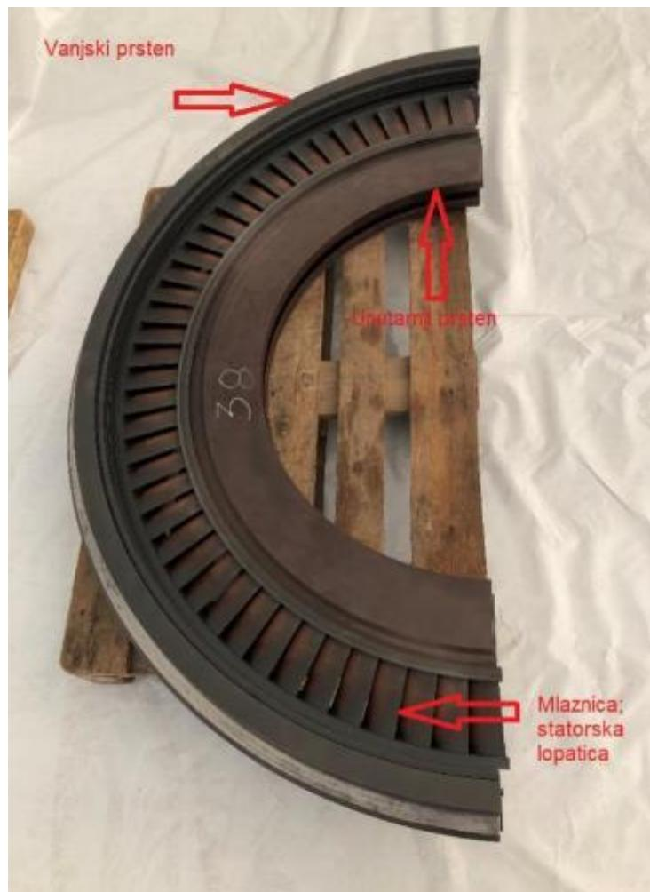
Slika 7. Osnovni dijelovi dijafragme
