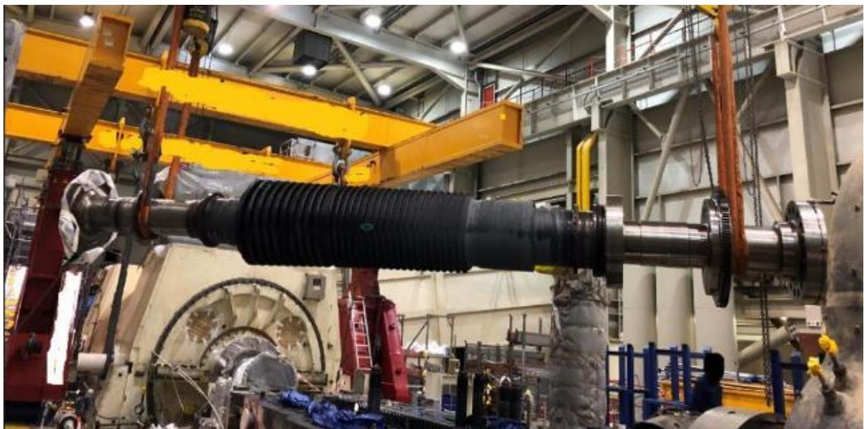
Slika 15. Rotor visokog tlaka
