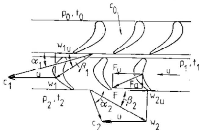
Slika 3. Projekcija cilindričnog presjeka turbinskog stupnja [6]
