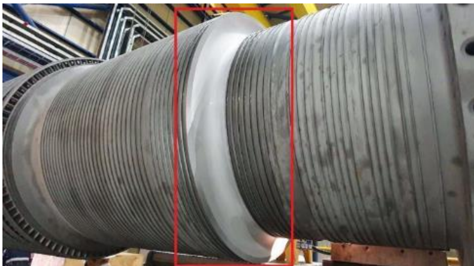
Slika 53. NDT nakon tokarenja konačne konture - bez indikacija
