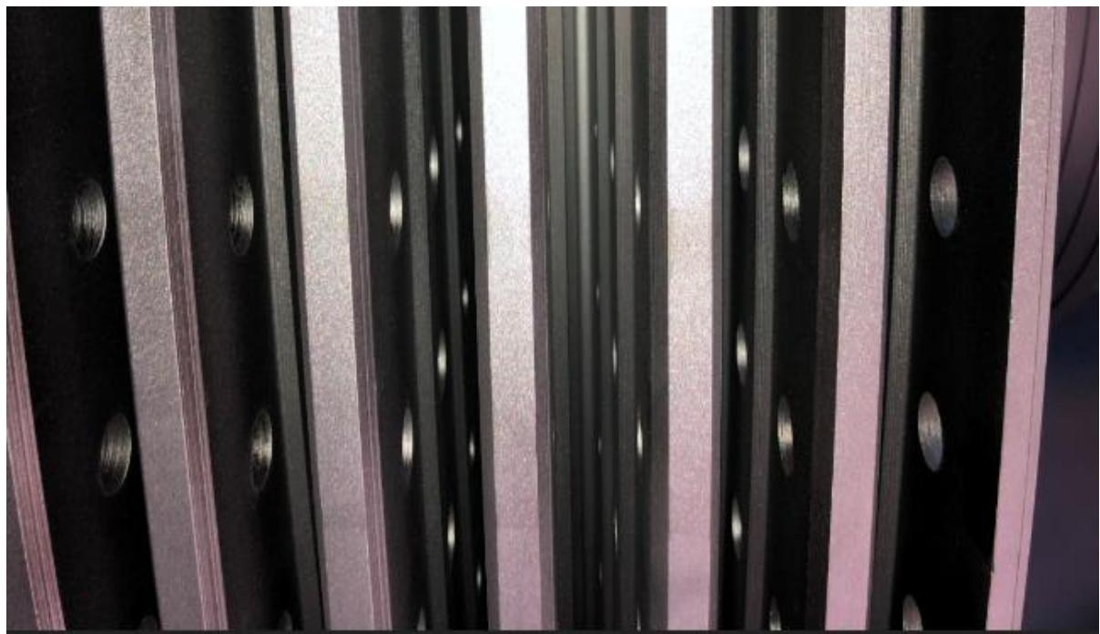
Slika 46. Prikaz utora na disku rotora, nakon pjeskarenja stakлом
