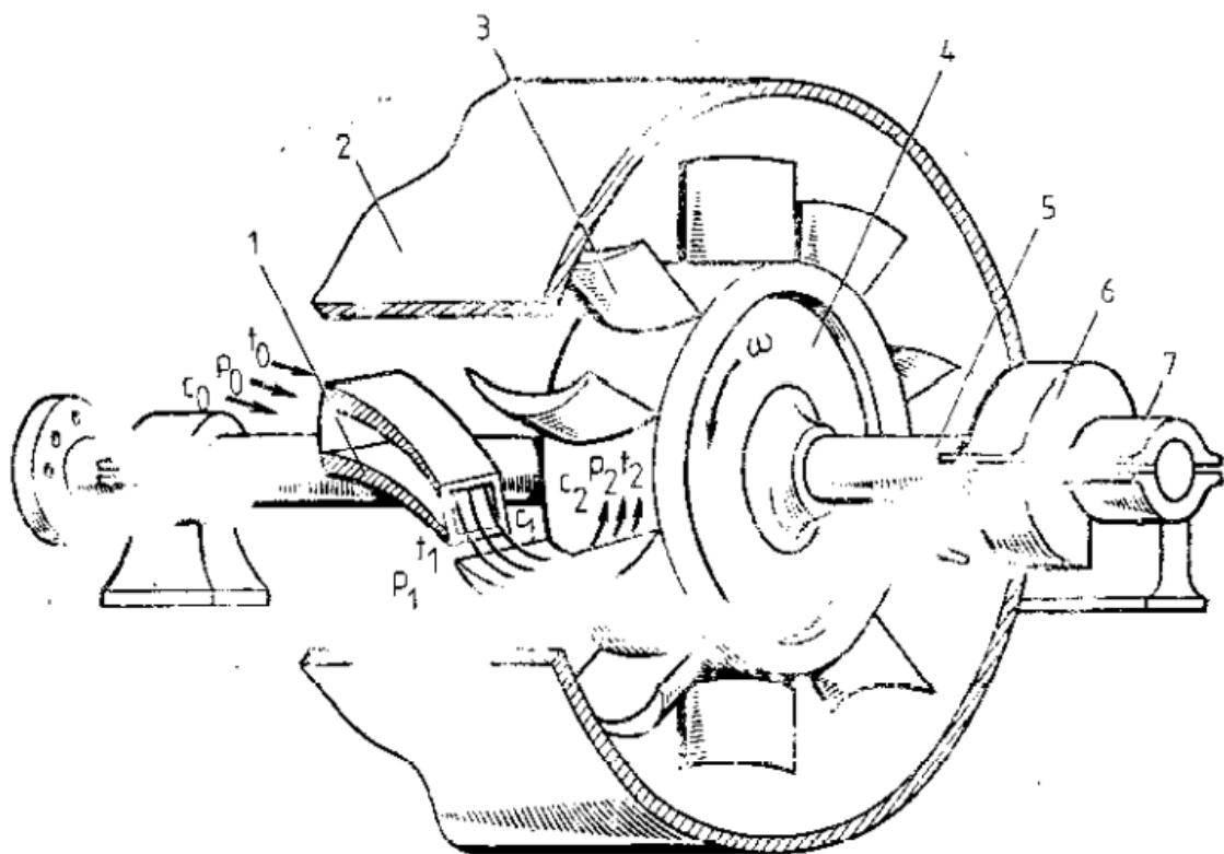
Slika 2. Aksijalna turbina s jednim stupnjem [6]
