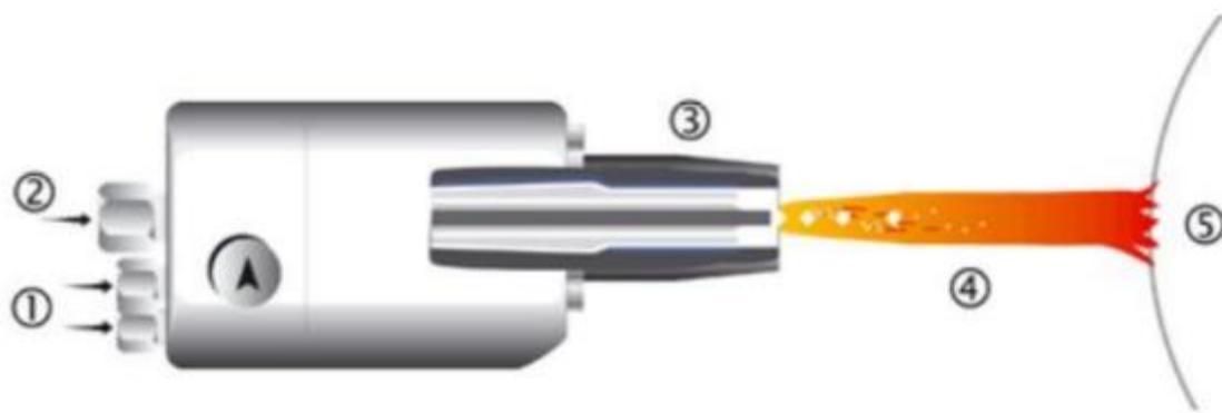
Slika 17. Prikaz postupka visokobrzinskog plamenog naštrcavanja [5]
