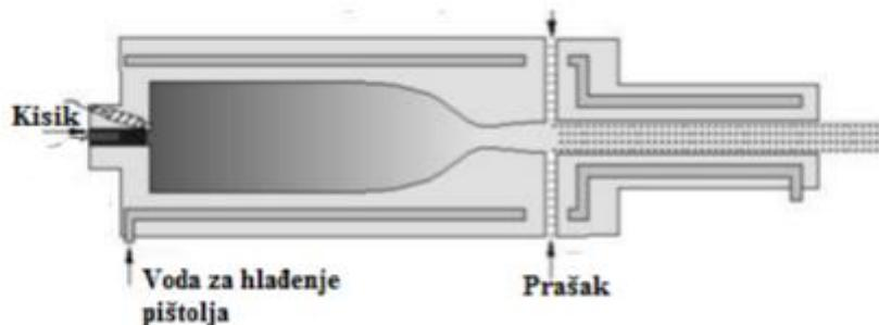
Slika 18. Pištolj za visokobrzinsko plameno naštrcavanje [5]
