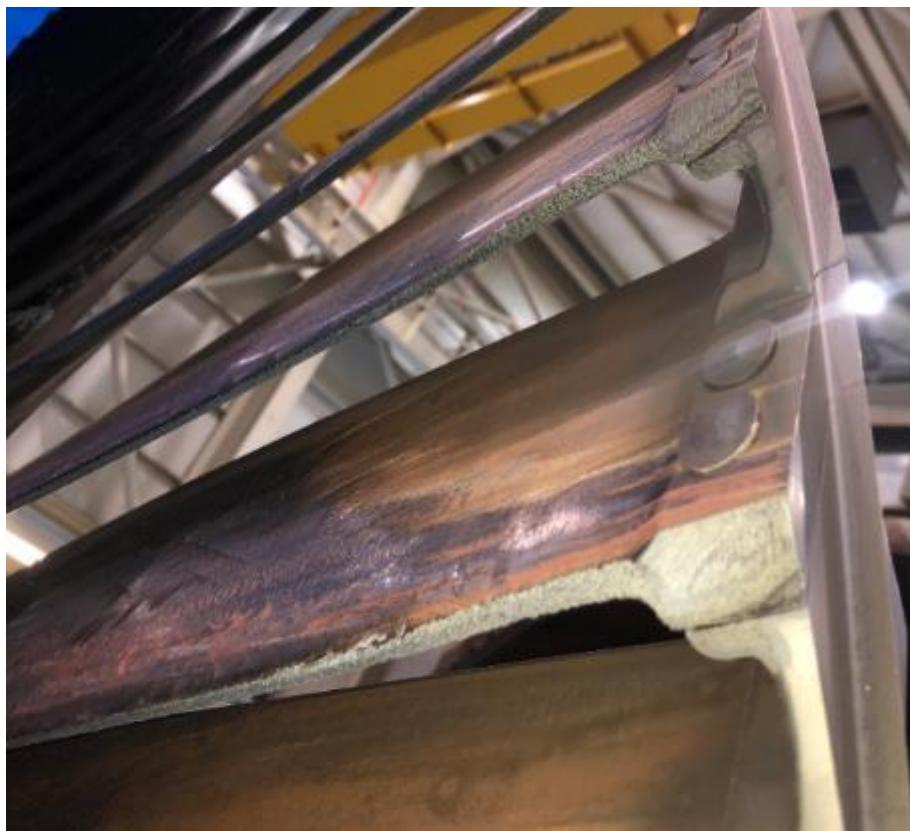
Slika 36. Erozija na zadnjem redu lopatica niskotlačnog rotora
