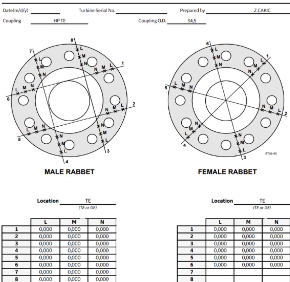
Slika 38. Mjerni protokol provjera ravnosti spojke [3]
