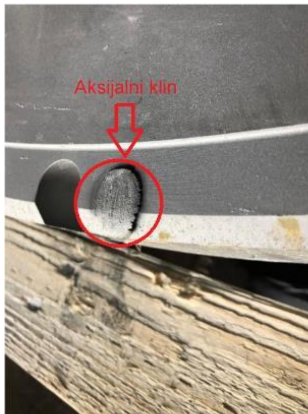
Slika 10. Nagnječenje aksijalnog klina
