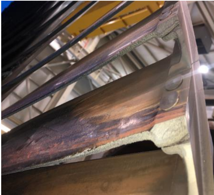
Slika 36. Erozija na zadnjem redu lopatica niskotlačnog rotora
