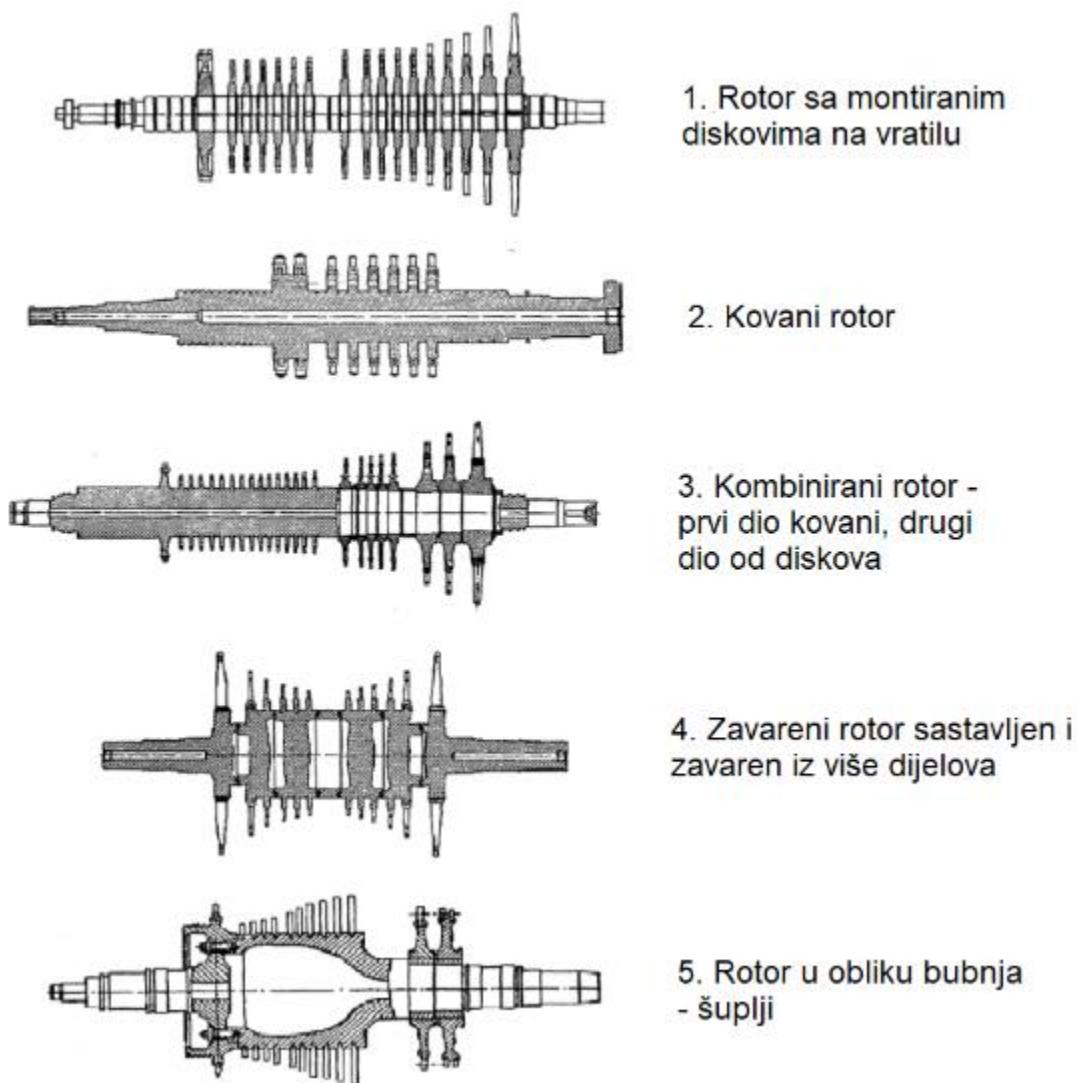
Slika 13. Podjela rotora prema načinu izrade [4]
