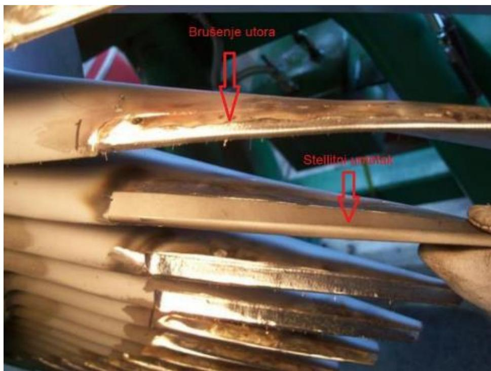
Slika 59. Priprema lopatica za lemljenje i zalemjeni umetak prije brušenja [3]
