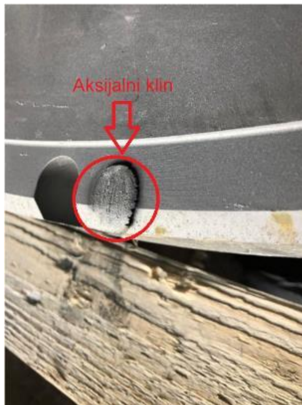
Slika 10. Nagnječenje aksijalnog klina
