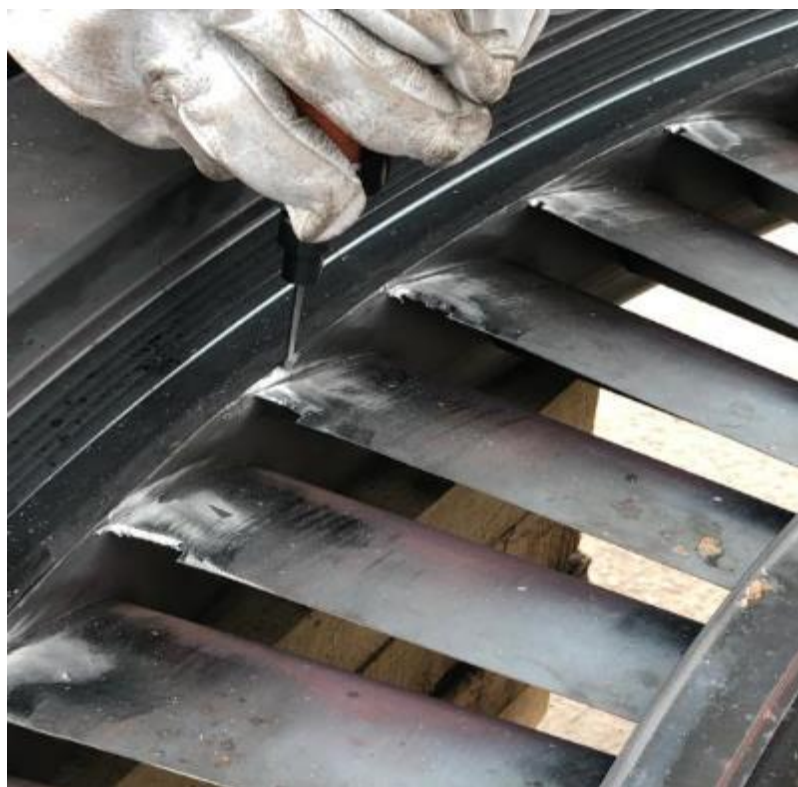
Slika 27. Izrezivanje oštećenih dijelova
