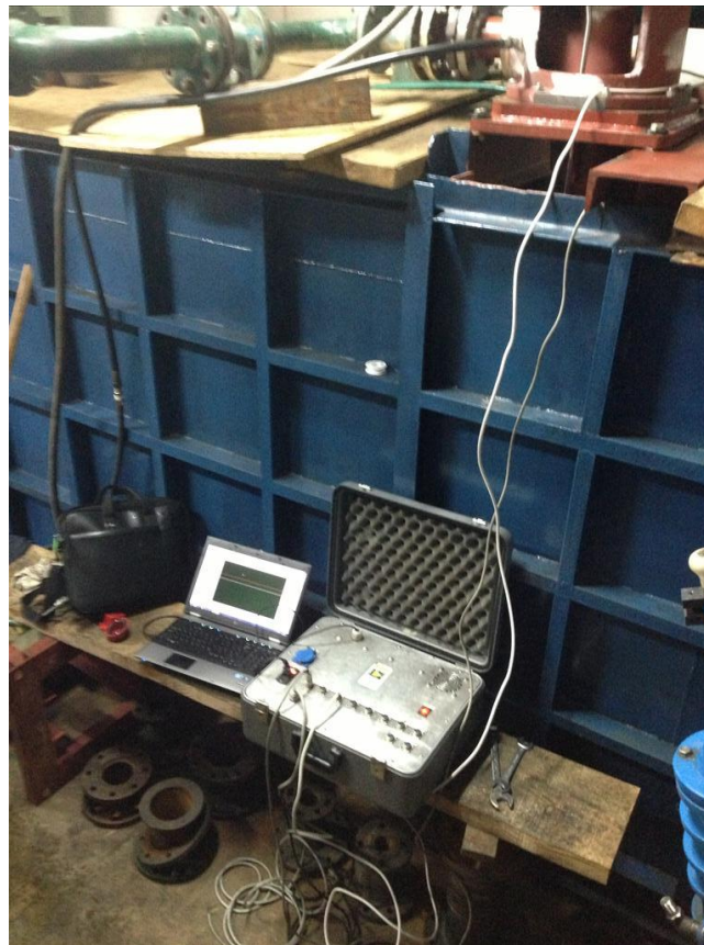
Slika 5. Mjerna opreme za vremensko praćenje temperature [9]
