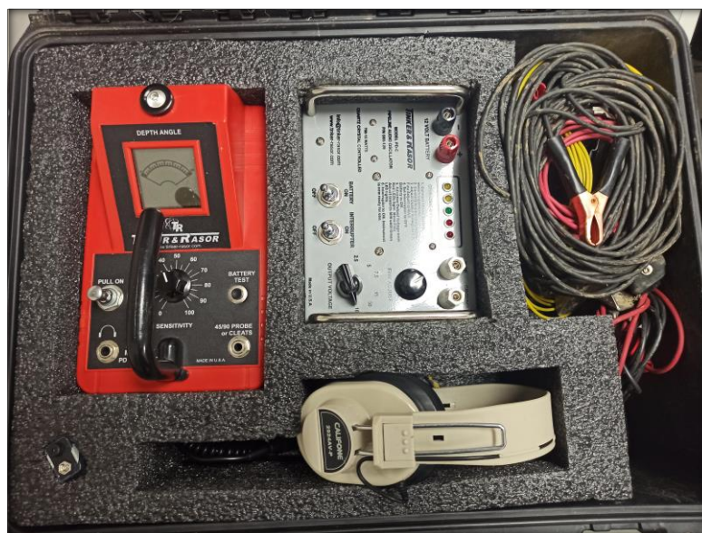
Slika 21. Uređaj za mjerenje oštećenja izolacije –MK-IV
