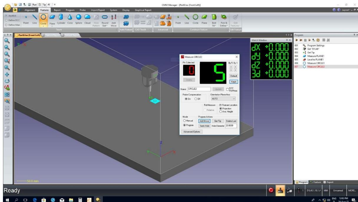
Slika 24. Mjerenje promjera i kružnosti za Ø17H8
