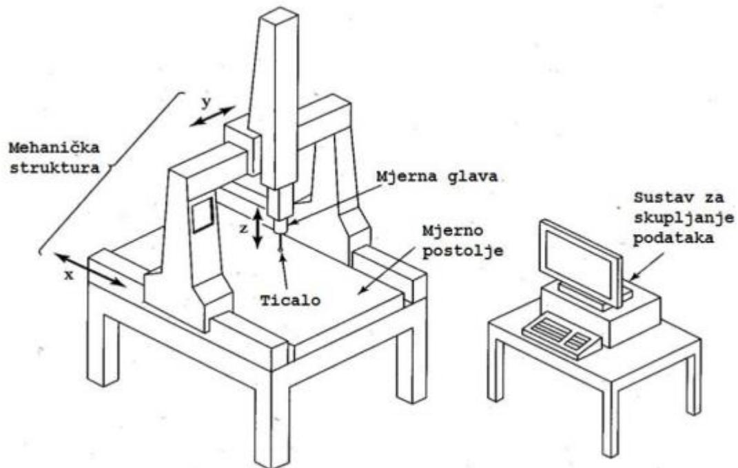
Slika 7. Sastavni dijelovi koordinatnih mjernih uređaja [9]
