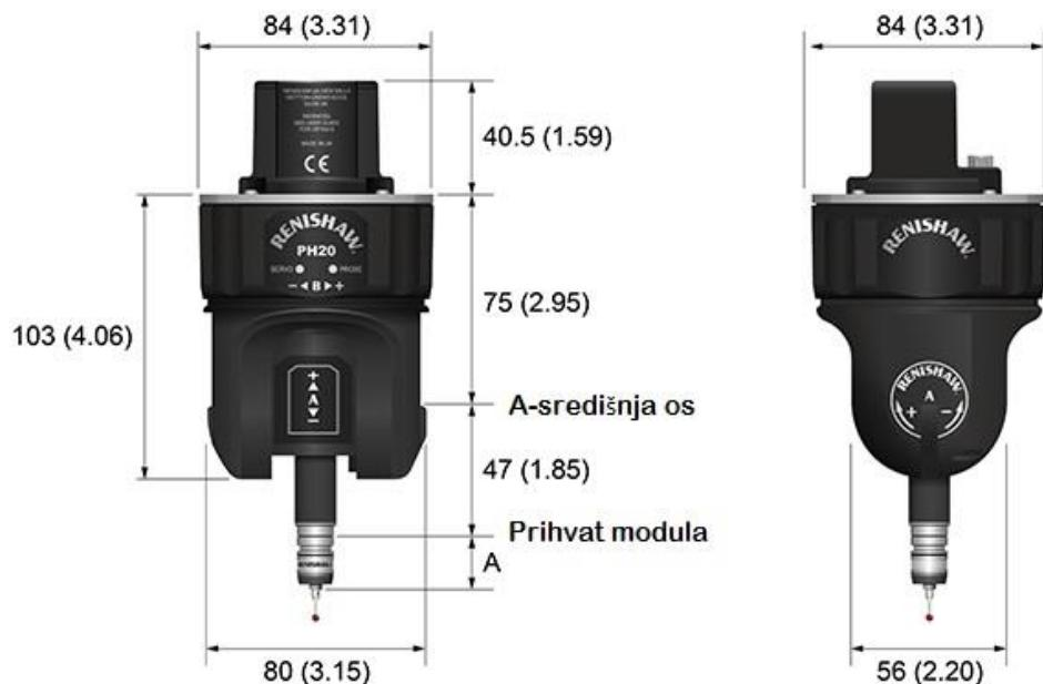
Slika 18. Dimenziye mjernog ticala Renishaw PH20
