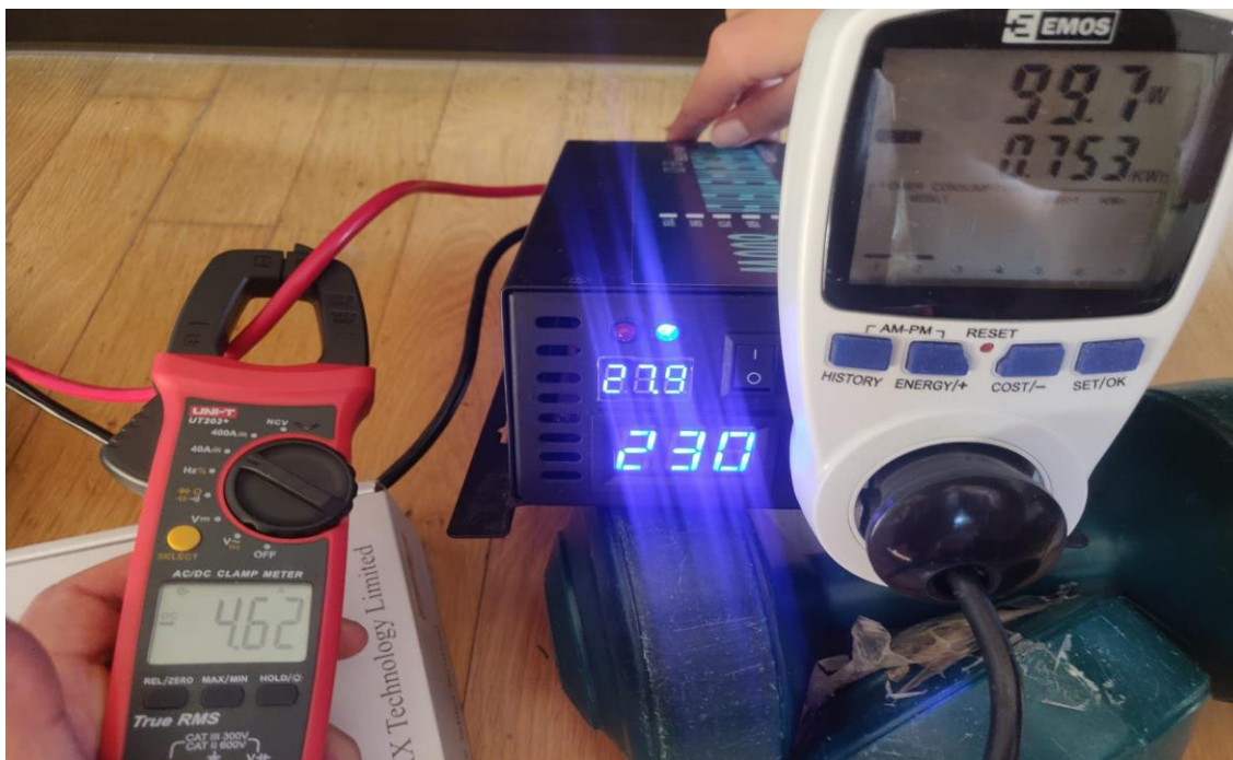
Slika 51. Mjerenje djelotvornosti invertera, 100[W] tereta
