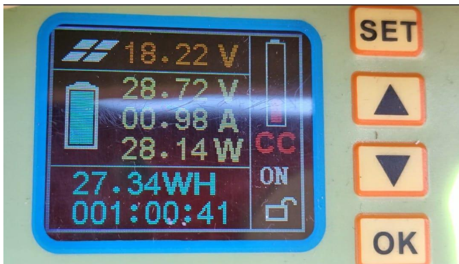
Slika 53. Vrijednosti solarnog punjenja na LCD-u kontrolera
