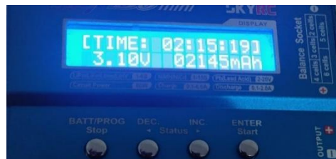
Slika 48. Vrijeme pražnjenja i vrijednost izmjerenog kapaciteta prvog uzorka
