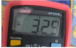
Slika 49. Preostali napon u ćeliji nakon pražnjenja
