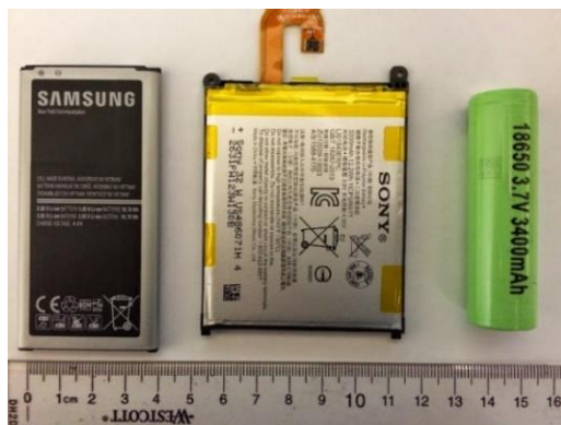
Slika 10. Dva najčešća fizička formata litij ion baterije
