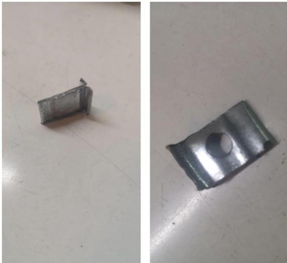
Slika 39. Dio za spoj klipnjače i klipa
