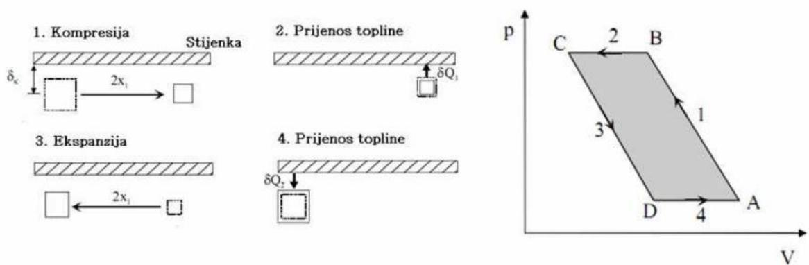
Slika 22. Pojednostavljeni lijevkretni termoakustički ciklus [4]
