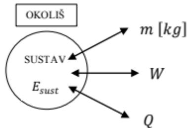
Slika 7. Termodinamički sustav [4]
