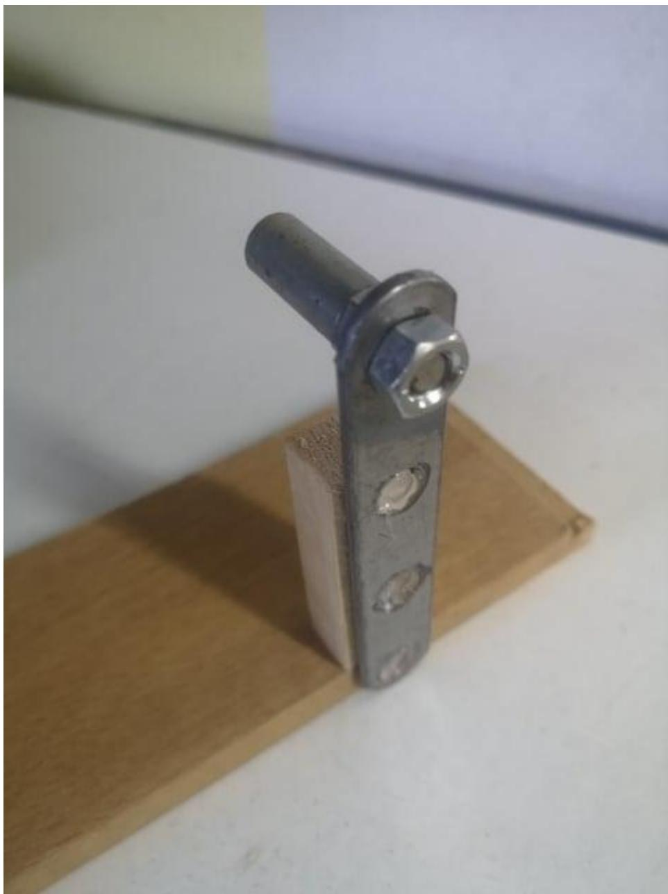
Slika 44. Postolje sa nosačem radnog kola
