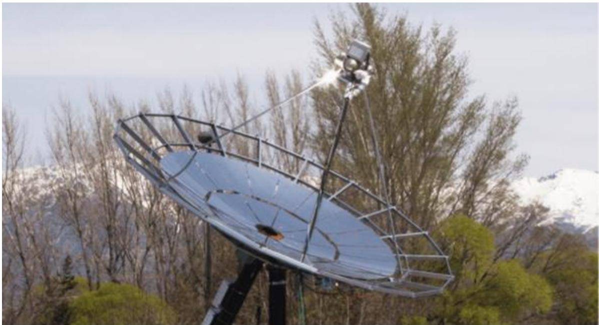
Slika 28. Solarni termoakustički stroj [12]
