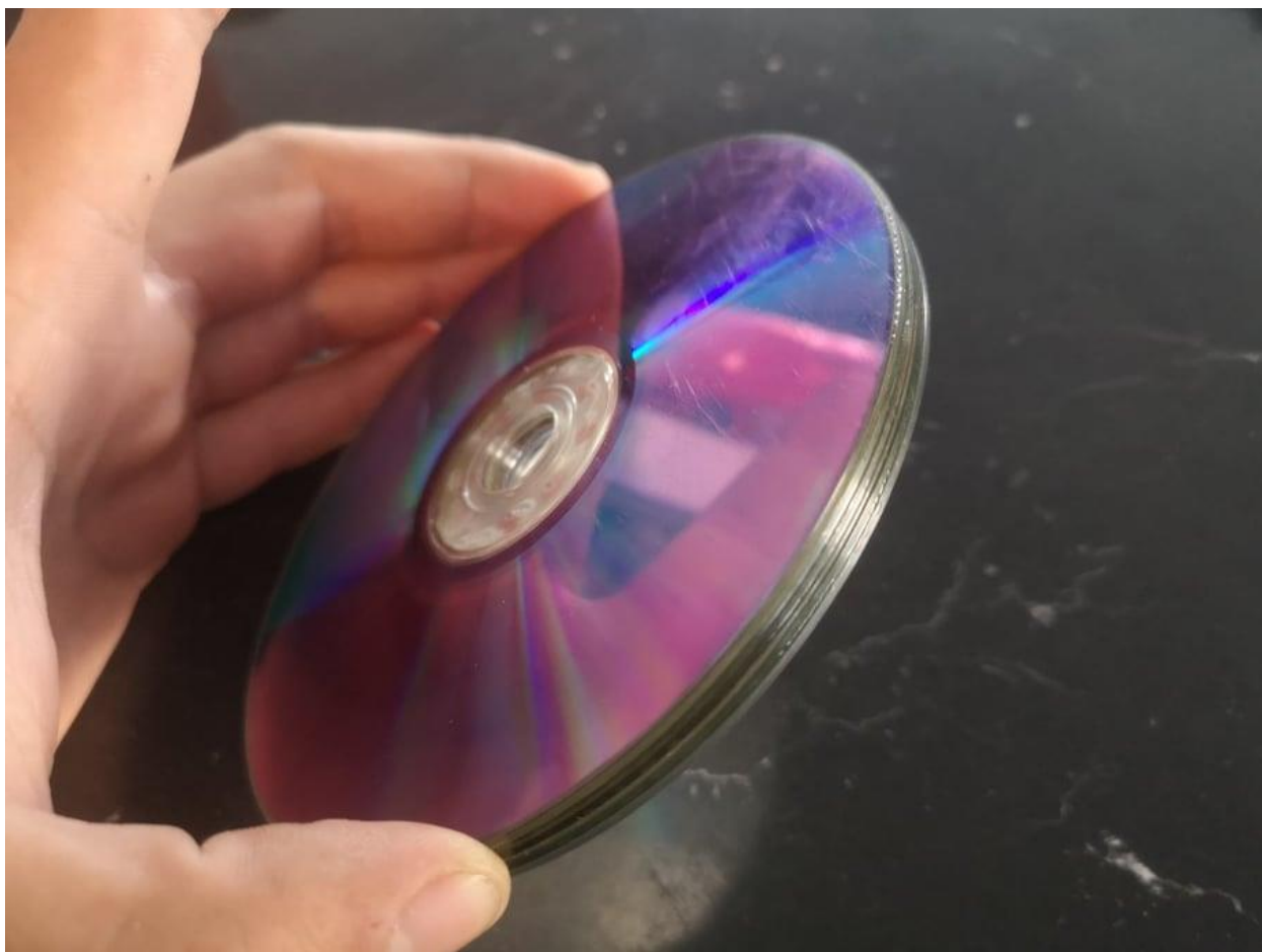
Slika 35. Spojeni CD diskovi u radno kolo
