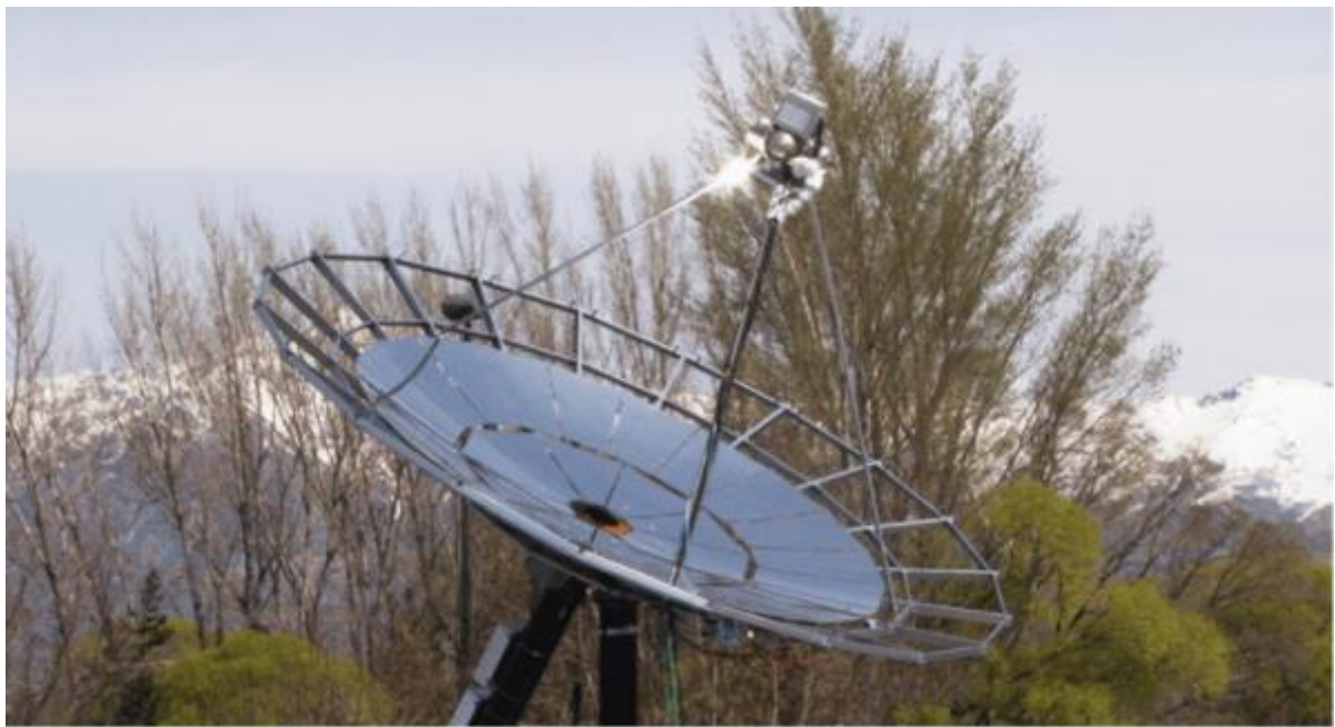
Slika 28. Solarni termoakustički stroj [12]
