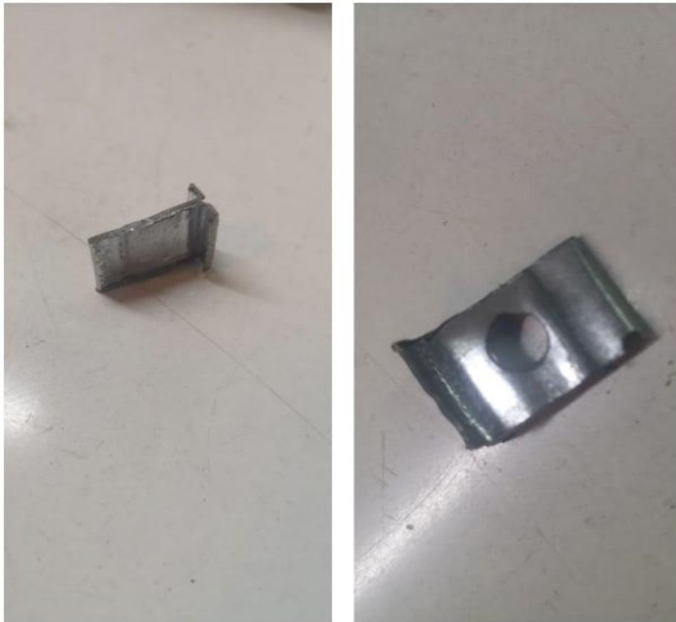
Slika 39. Dio za spoj klipnjače i klipa
