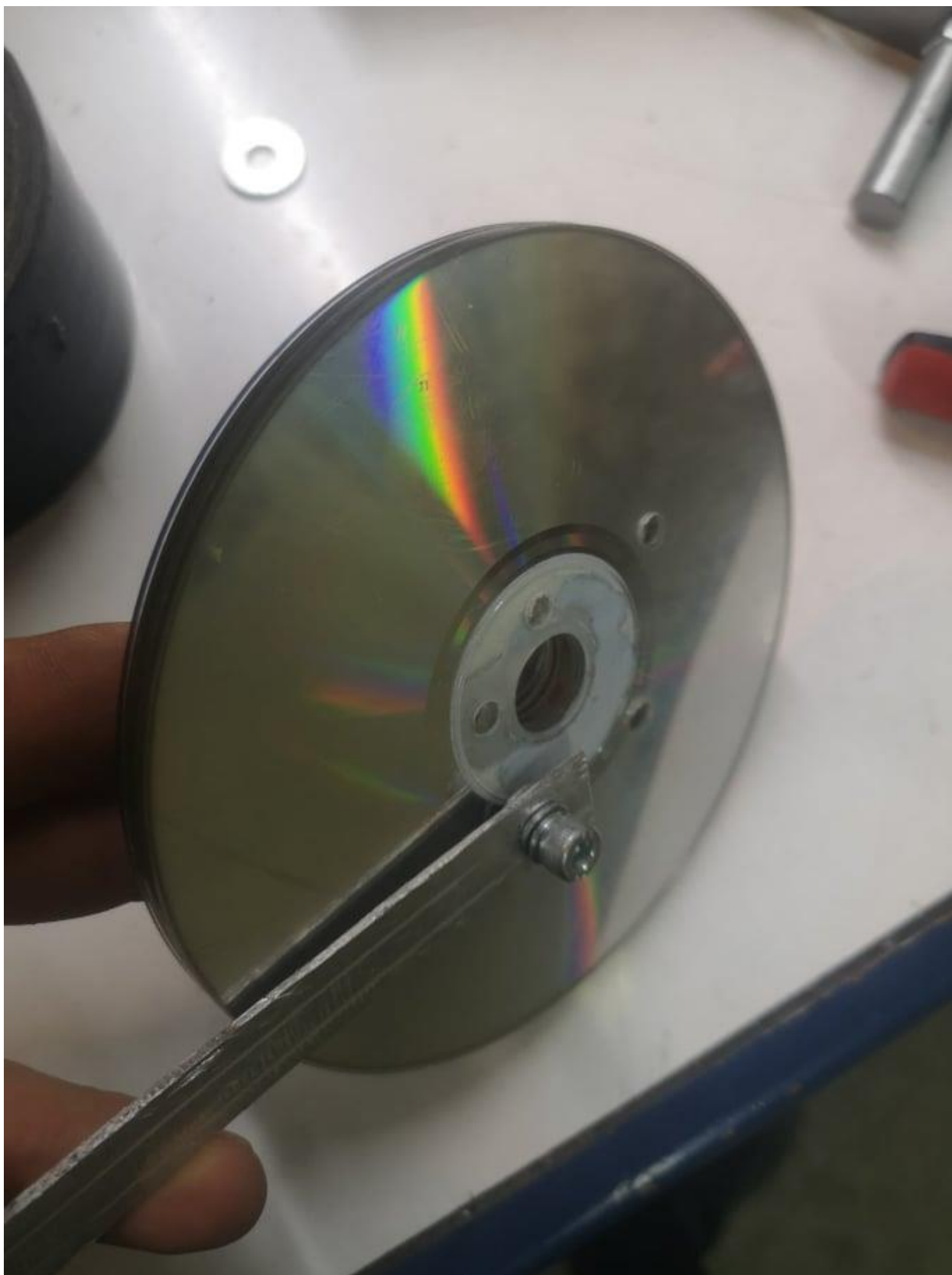
Slika 42. Spoj klipnjače sa radnim kolom
