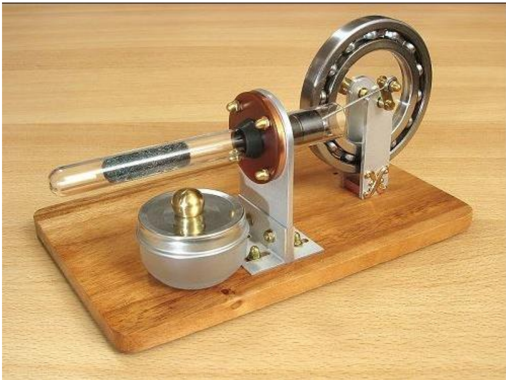
Slika 29. Termoakustički Stirlingov stroj [11]
