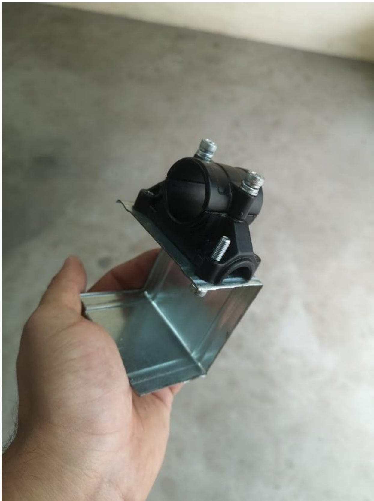
Slika 32. Spoj prvog i drugog dijela nosača
