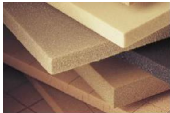
Slika 18. PVC – polimerne pjene [8]
