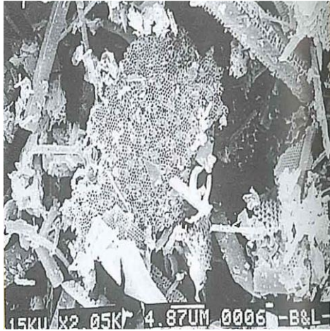
Slika 6. Fini Kieselghur (povećanje pod mikroskopom 1000x) (Kunze, 2010)
