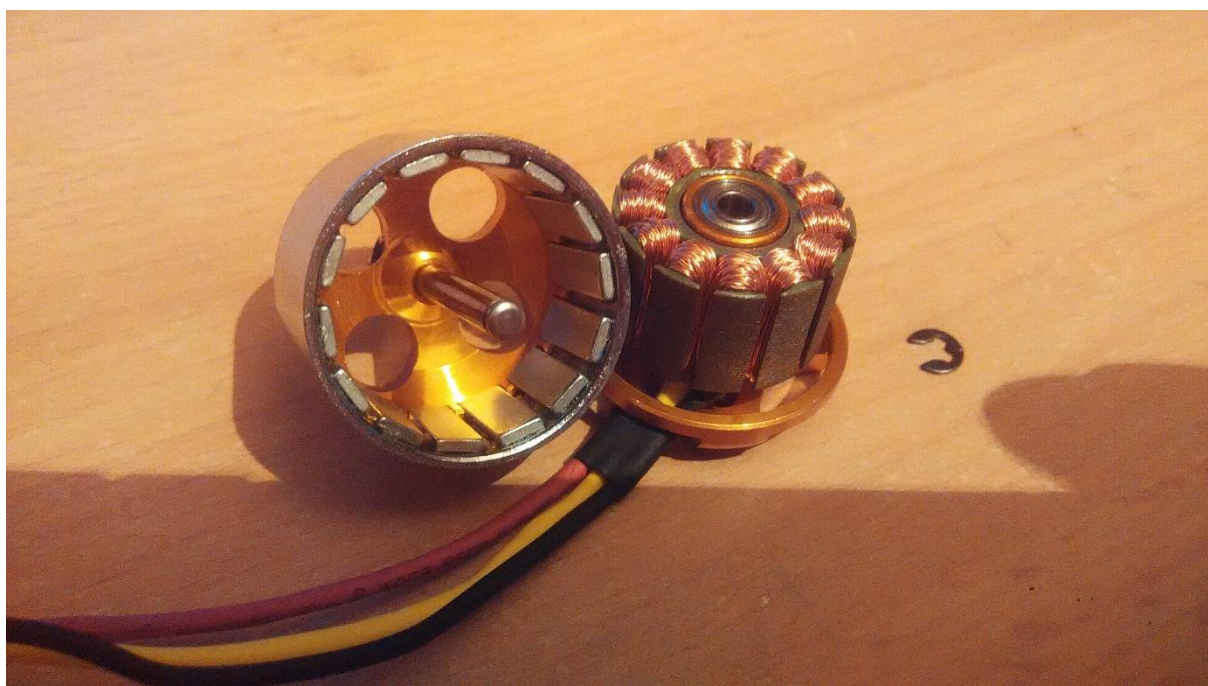
Slika 10. Otvoreni DC motor bez četkica
