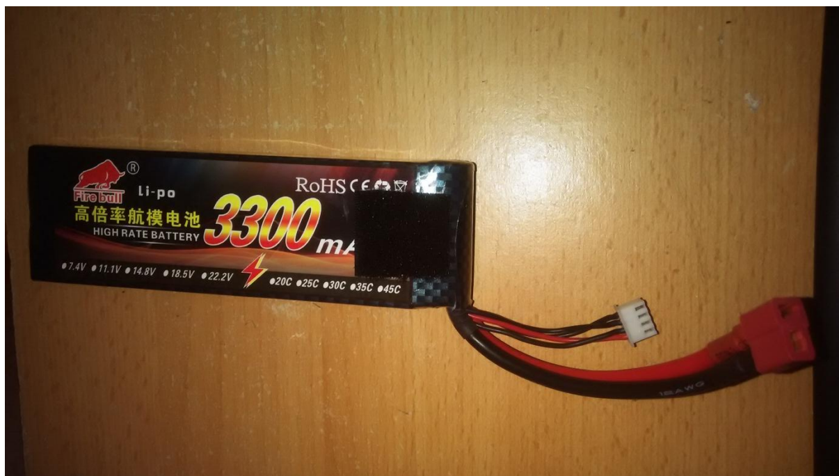
Slika 16. Fire Bull 3S 3300 mAh 25C baterija
