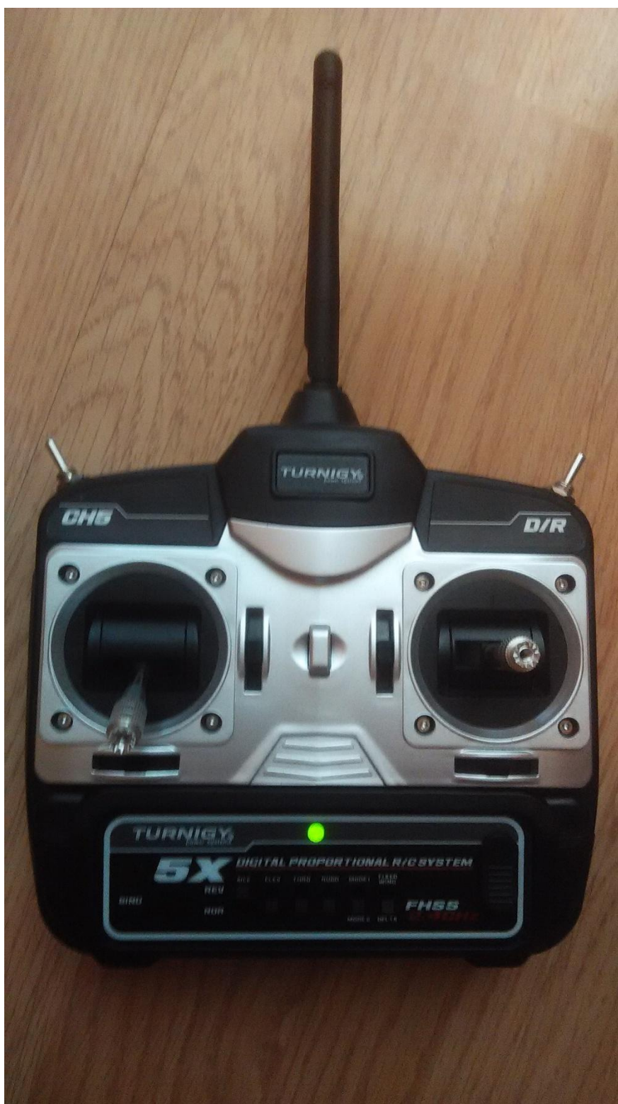
Slika 17. Turnigy 5x odašiljač
