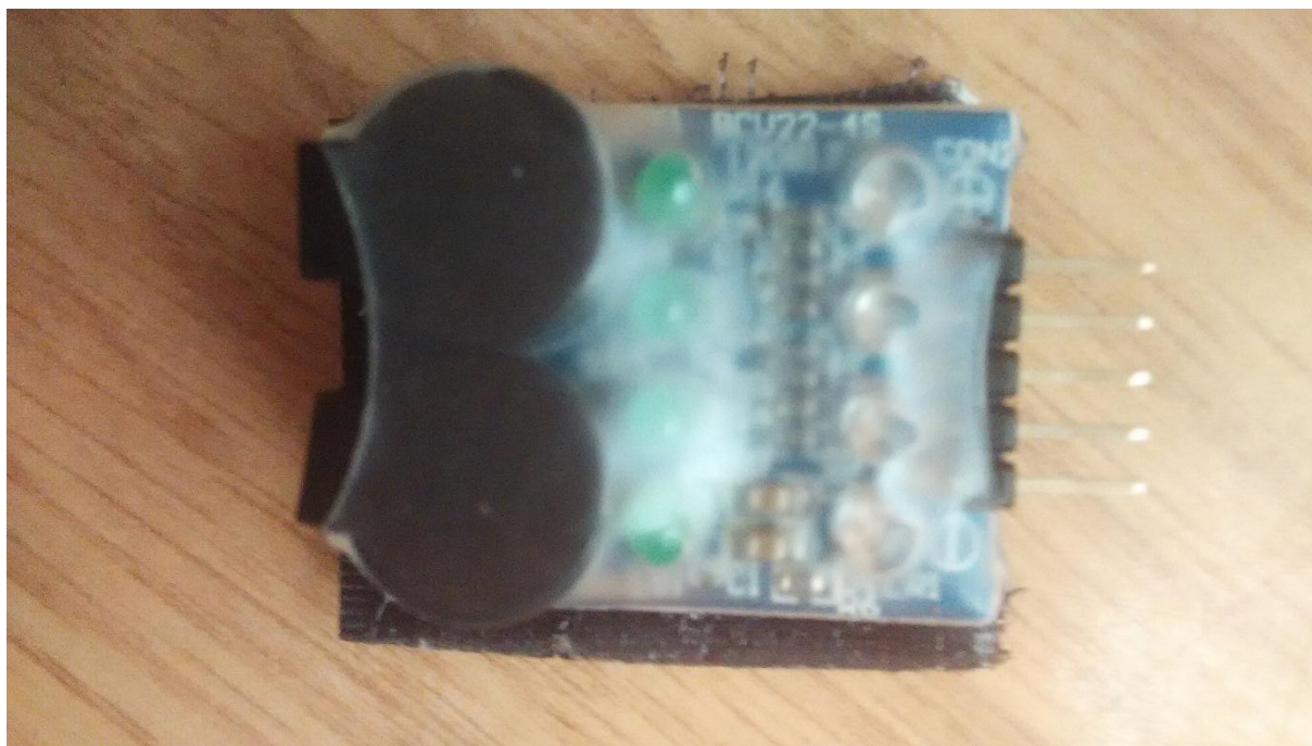
Slika 26. Indikator napona litijske baterije
