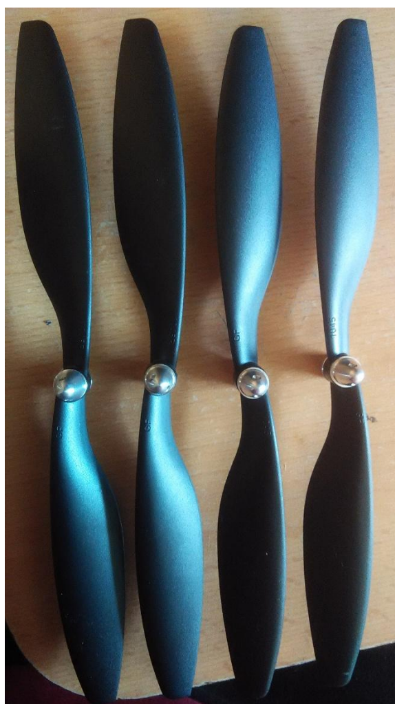
Slika 12. Plastični propeleri oznake 1045
