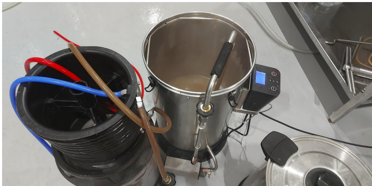
Slika 4. Grainfather sistem za kućno pivarstvo (Izvor: Autor)
