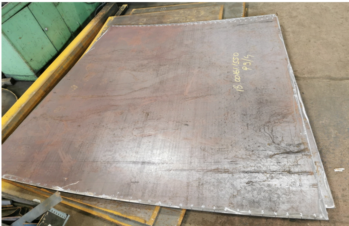
Slika 10.2 Ocrtane linije savijanja p.9/4.
