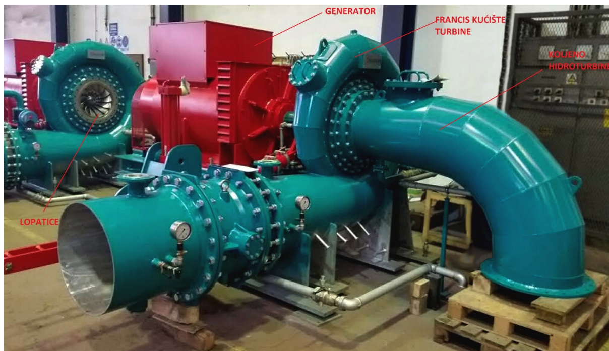
Slika 2.2.2 Djelovi francis hidroturbine.
