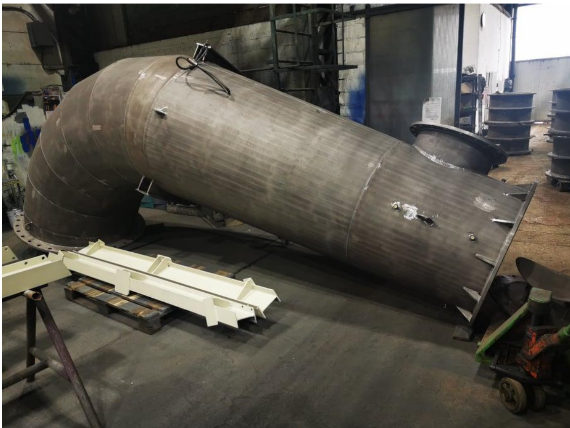
Slika 14.4 Pjeskarena pozicija na pripremi za ličenje.
