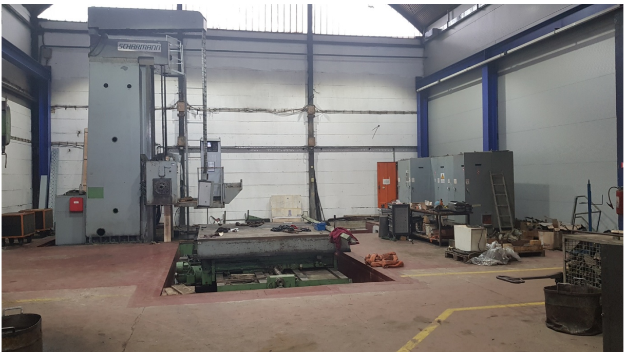
Slika 5.7 Borverk Scharmann WFT 160 NCC.
