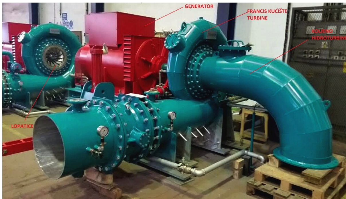
Slika 2.2.2 Djelovi francis hidroturbine.
