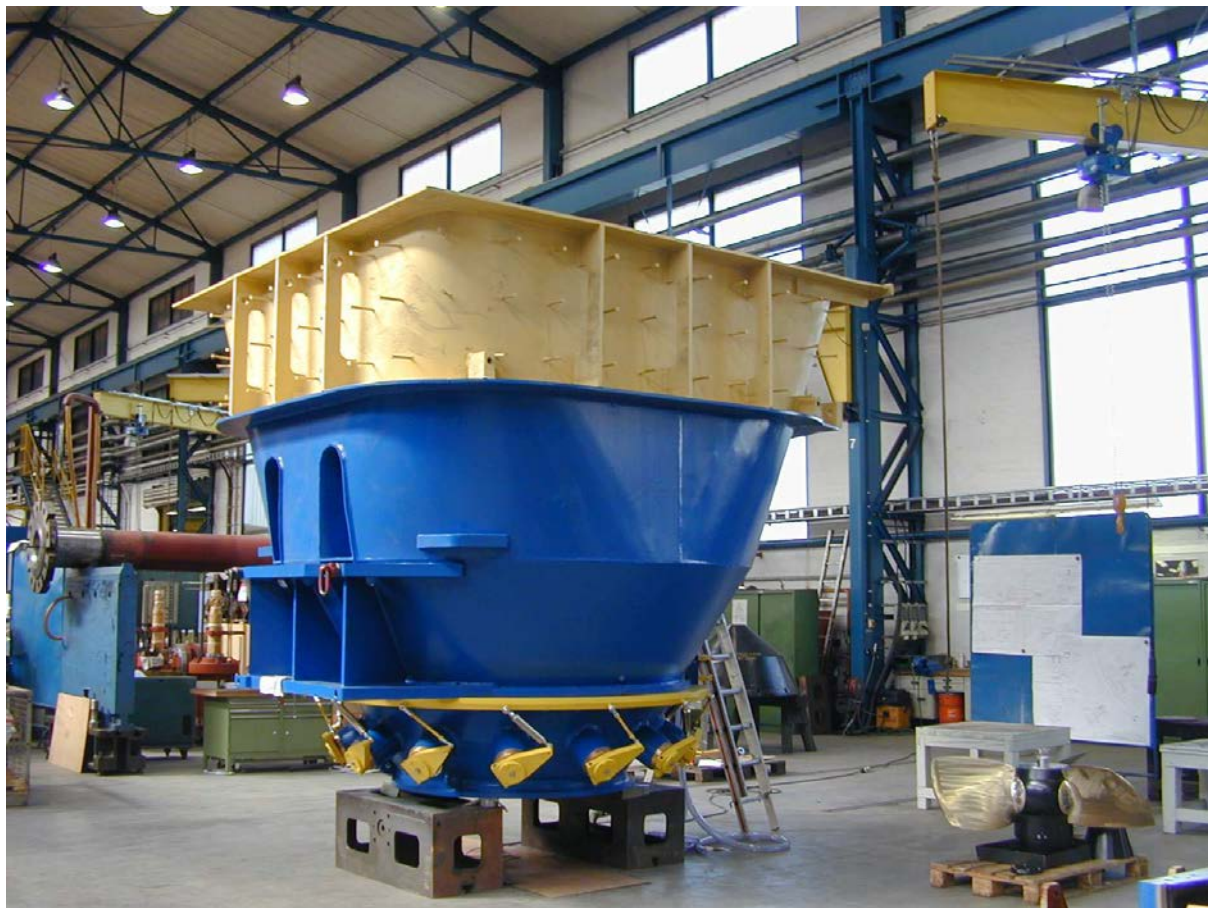
Slika 2.3.4 Kućište kaplan turbine proizvedeno u AB Produktu.
