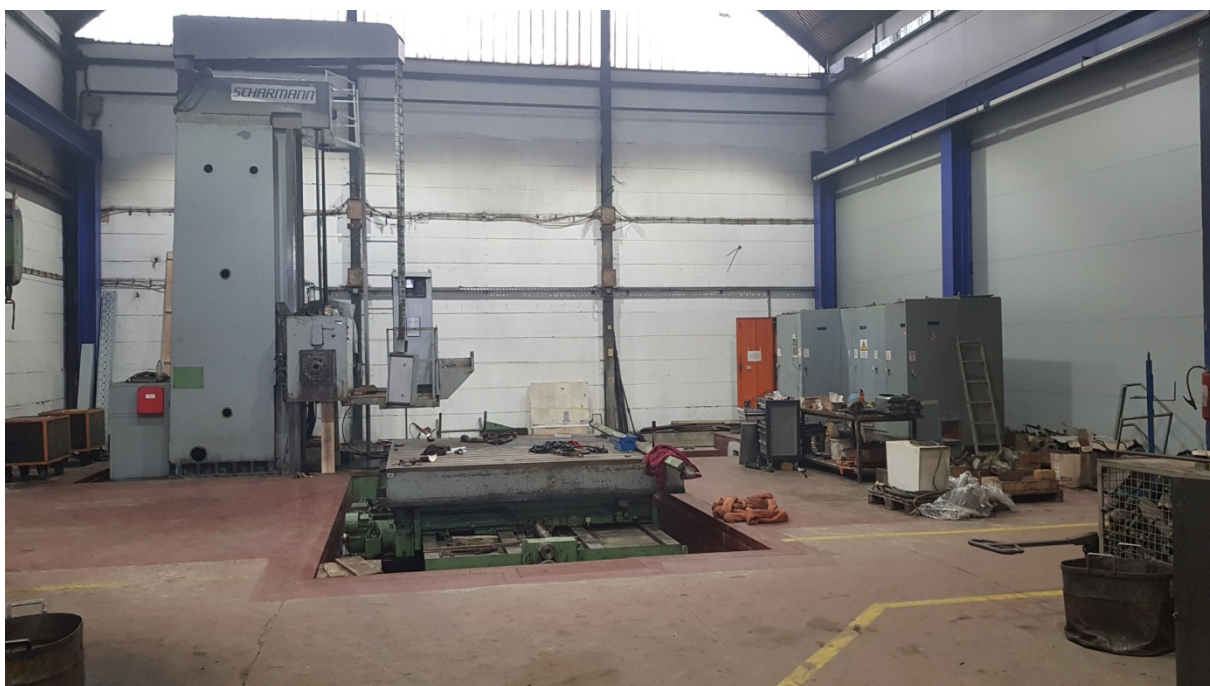
Slika 5.7 Borverk Scharmann WFT 160 NCC.
