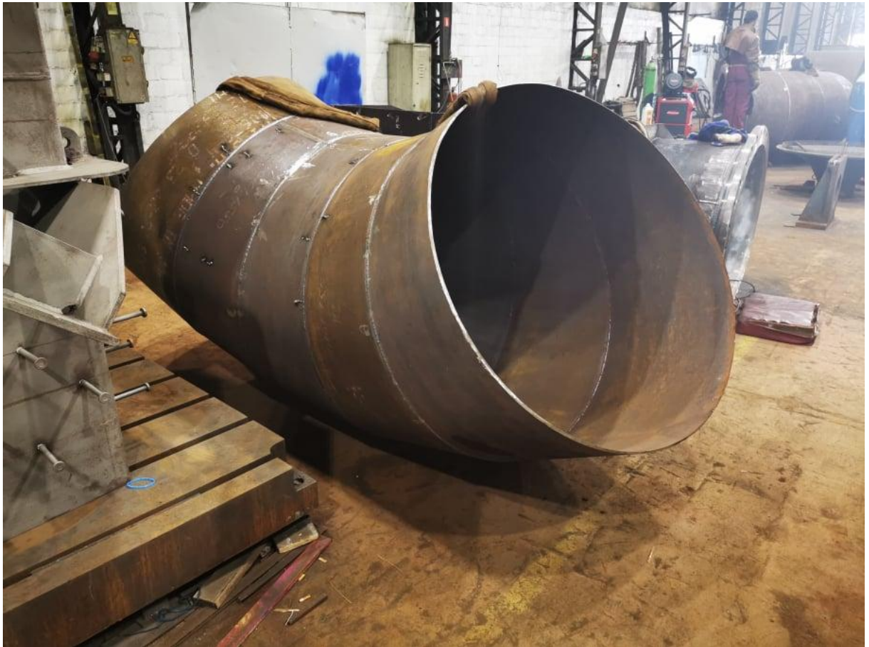
Slika 14.1 Savinute i bravarski složene pozicije 2 (5kom).
