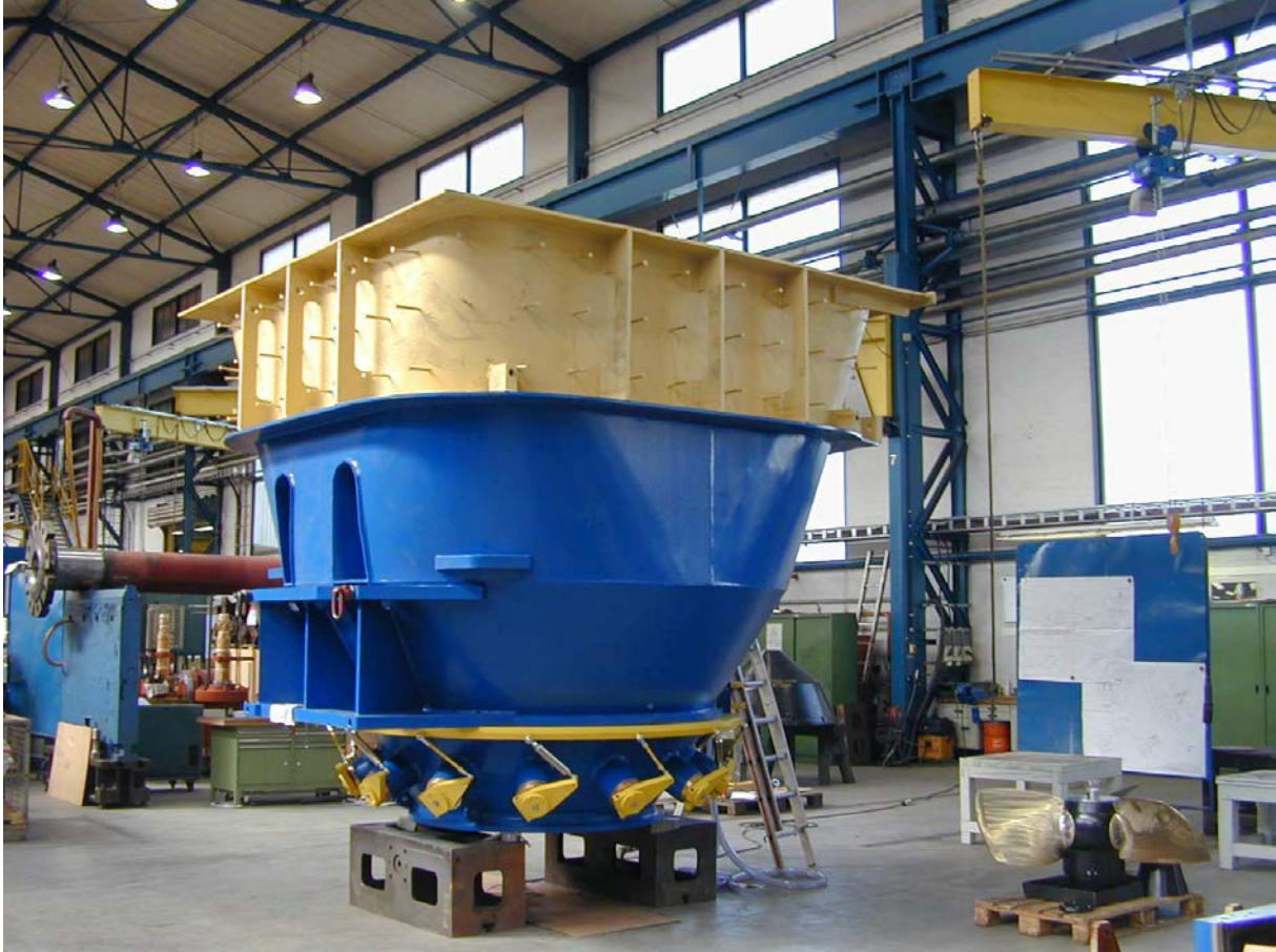
Slika 2.3.4 Kućište kaplan turbine proizvedeno u AB Produktu.
