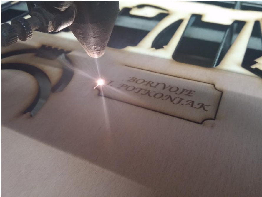
Slika 4: Lasersko graviranje i izrezivanje
