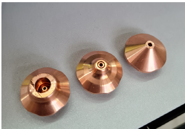
Slika 21. Sapnica laserske glave
