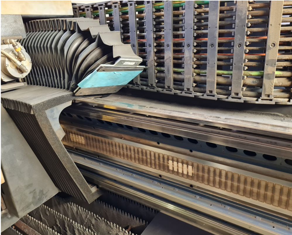
Slika 22. Čišćenje, kontrola i podmazivanje vodilica laserske glave
