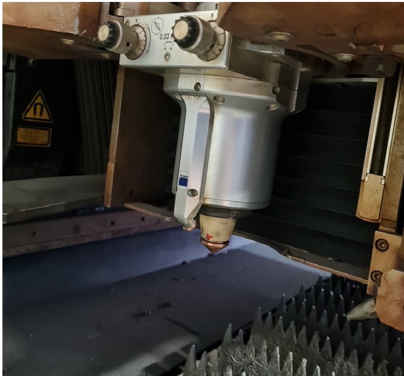
Slika 24. Kontrola i podešavanje sapnice laserske glave
