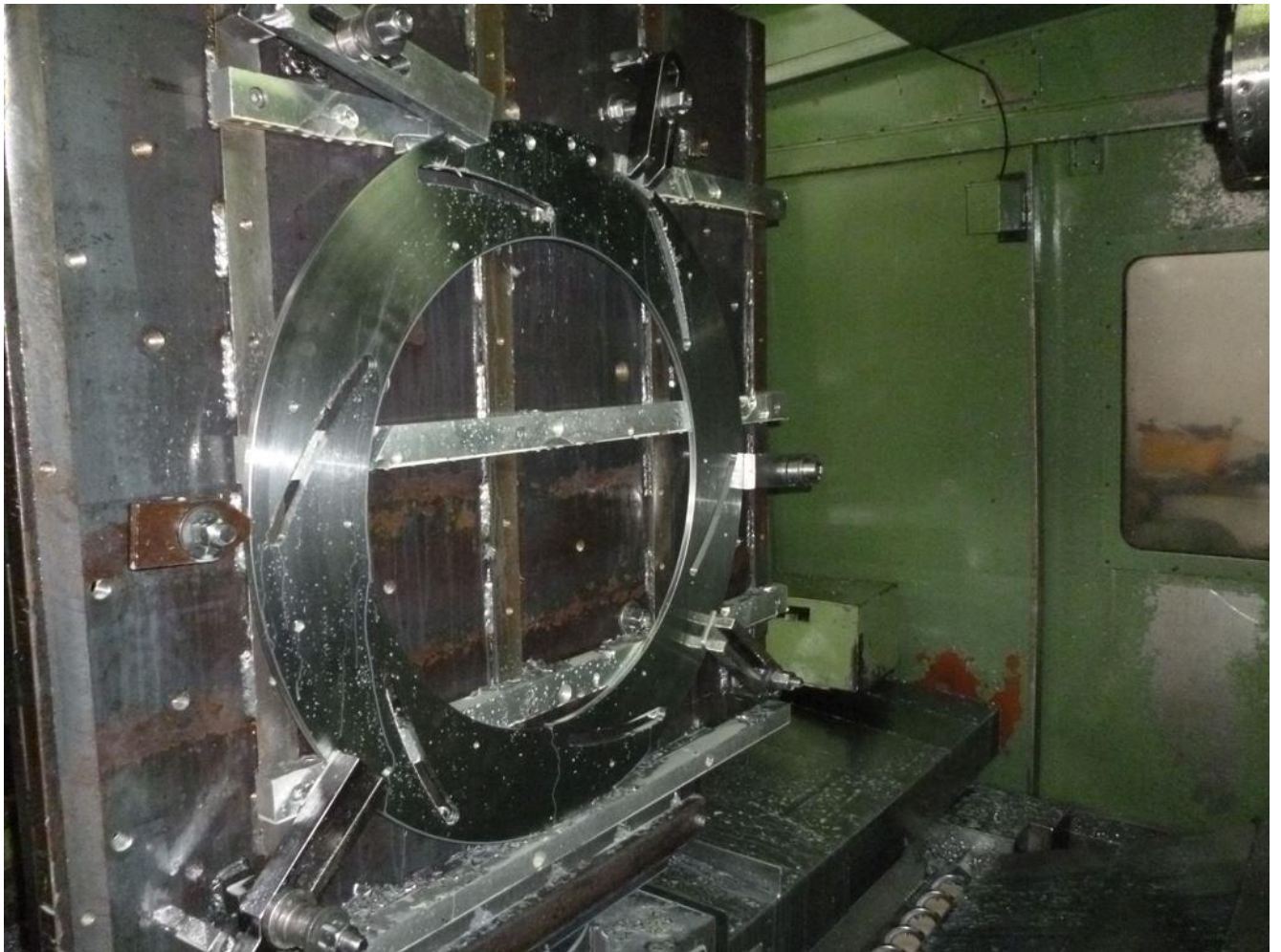
Slika 17. Obrada bušenja provrta, urezivanja navrta i glodanja utora
