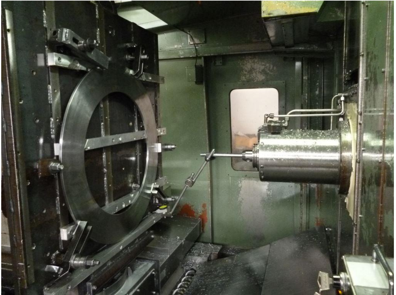
Slika 16. Horizontalni obradni centar H-15, centriranje komada
