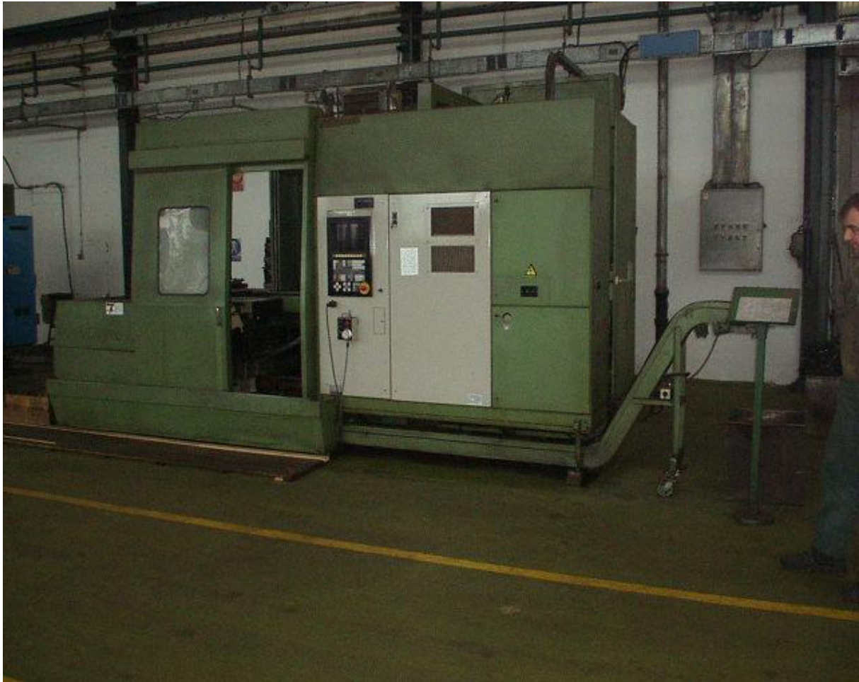
Slika 11. Horizontalni obradni centar H15- MB
