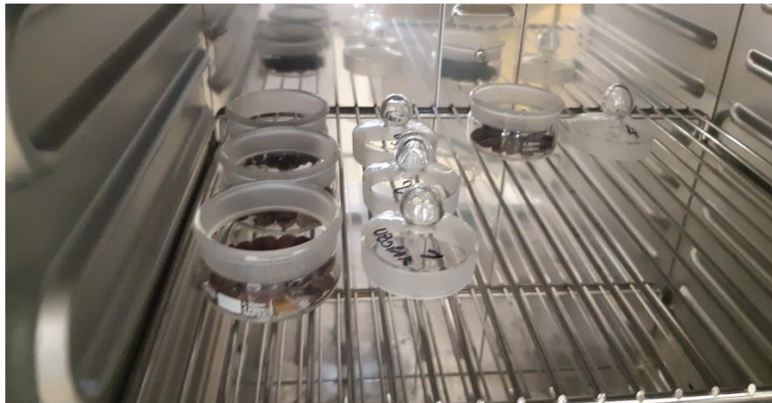
Slika 14 Sušenje posudica s uzorcima kave u sušioniku. Izvor: (osobna fotografija).
