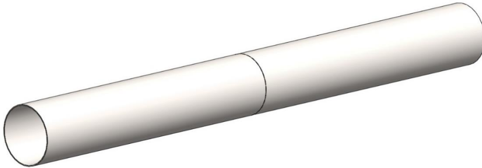
Slika 31 Plašt napravljen spajanjem dvije cijevi
