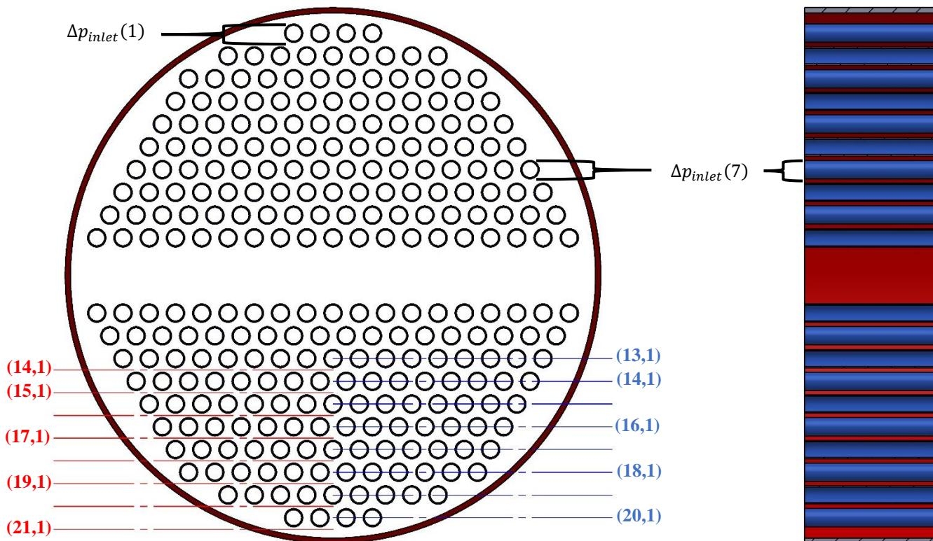
Slika 20 Grafički prikaz pada tlaka na ulazu izmjenjivača
