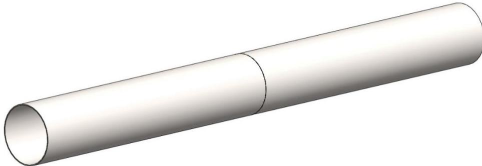
Slika 31 Plašt napravljen spajanjem dvije cijevi
