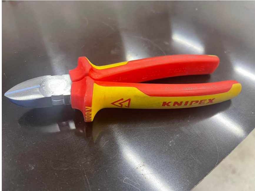
Slika 8. Izolirana kliješta za sječenje 1000V [Vlastiti izvor]
