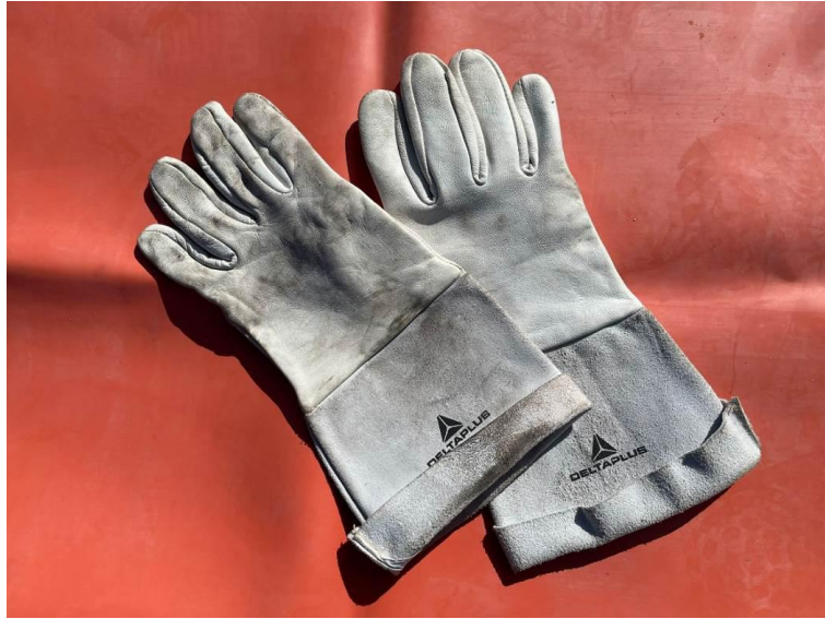
Slika 4. Zaštitne kožne rukavice (nadrugavice) [Vlastiti izvor]
