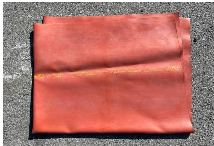
Slika 9. Izolacijska prekrivka [Vlastiti izvor]
