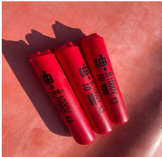
Slika 11. Izolacijske zaštitne kapice [Vlastiti izvor]
