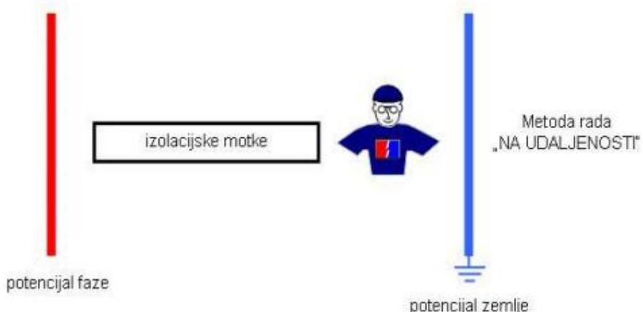
Slika 13. Metoda rada „na udaljenosti“
