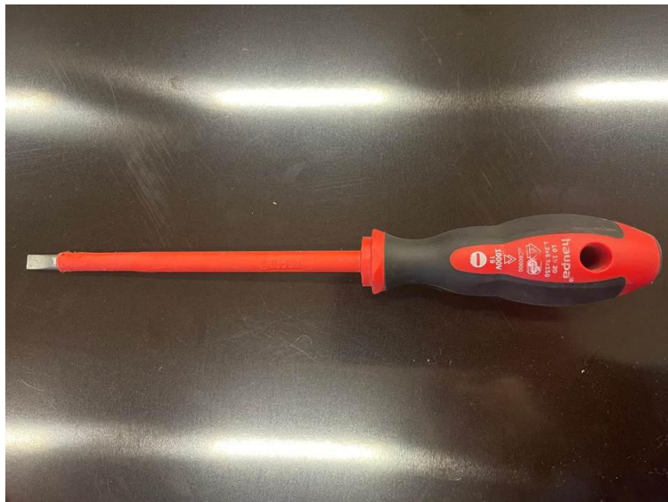
Slika 7. Izolirani odvijač 1000V [Vlastiti izvor]
