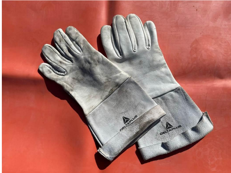
Slika 4. Zaštitne kožne rukavice (nadrugavice) [Vlastiti izvor]
