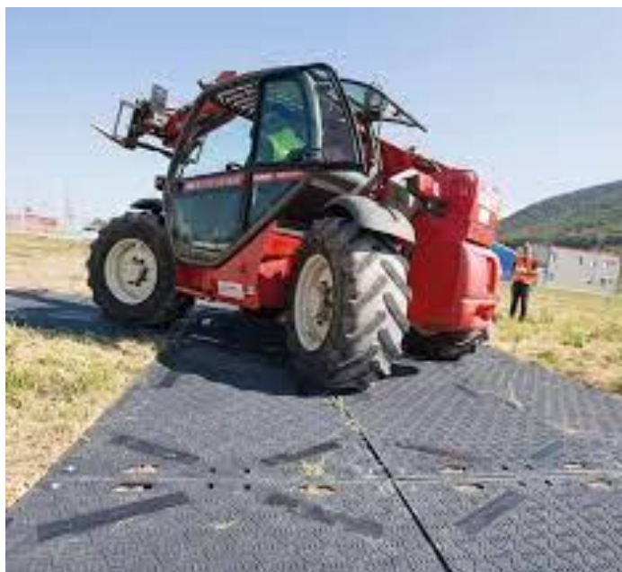
Slika 8. Kretanje kranskog viličara po Isotrack L serija umjetnim podlogama ( https://www.isotrack.eu/images/pdf/Isotrack-L-brochure.pdf )
