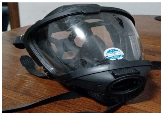
Slika 14. Maska za cijelo lice (Vlastita izrada)
