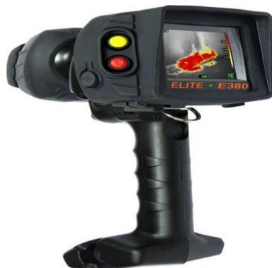
Slika 6. Termo kamera (Izvor: https://tehprojekt.com/ )
