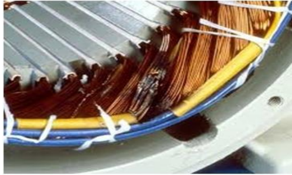
Slika 3. Oštećeni elektromotor (Izvor: www.pinterest.com )
