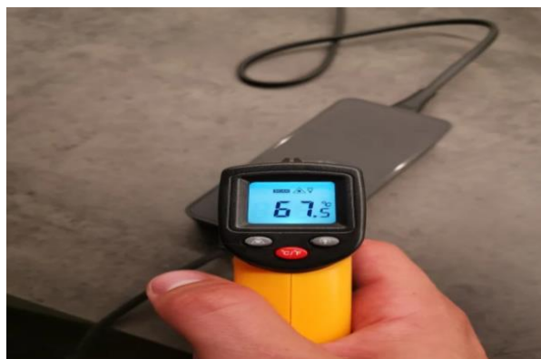
Slika 5. Mjerenje temperature punjača (Izvor: www.reddit.com )
