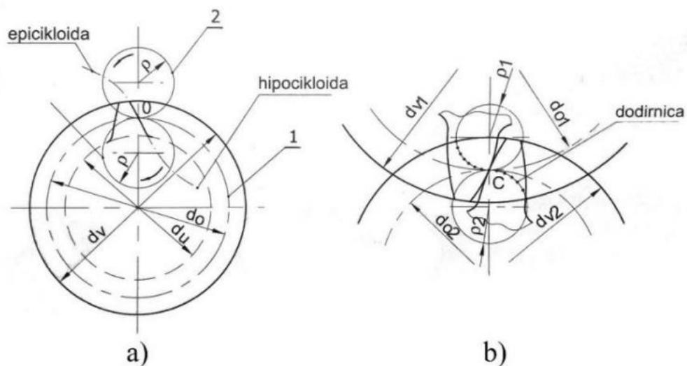
Slika 7. a) nastanak profila boka cikloidnog zupca. Izvor [13].
