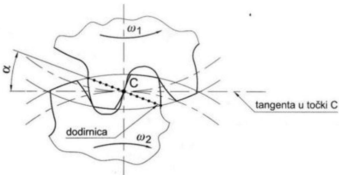
Slika 6. Dodirnica kuta i dodirnica evolventnog ozubljenja. Izvor [6].
