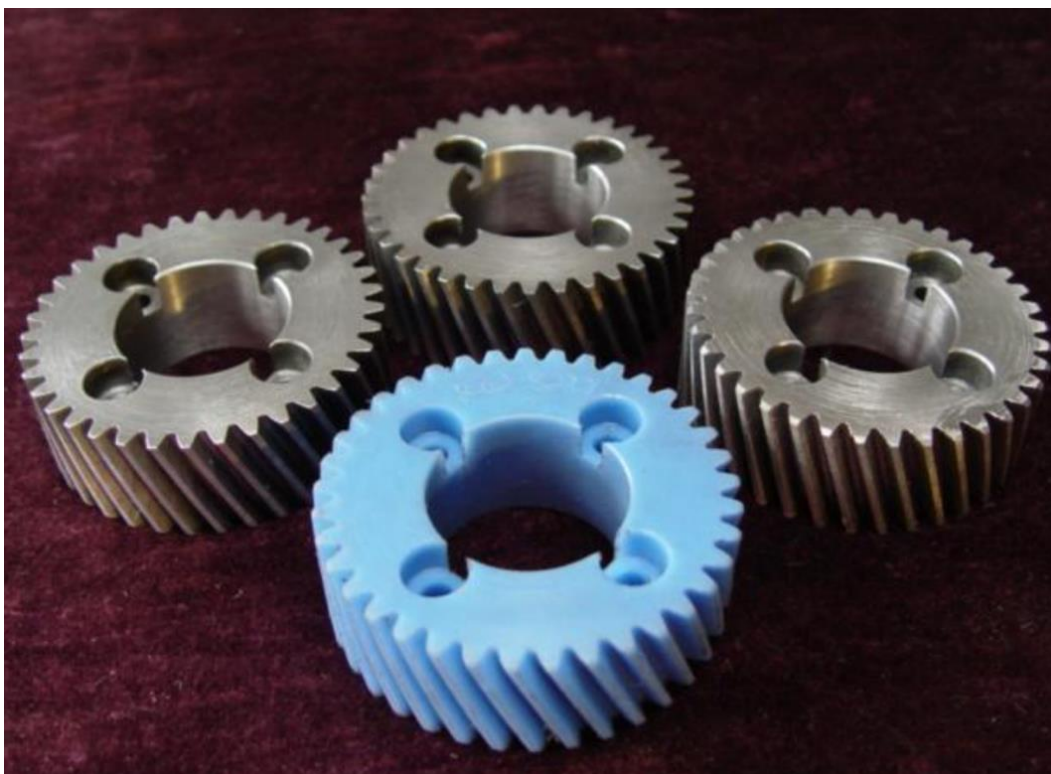
Slika 8. Plastični (nemetalni) zupčanici. Izvor [13].
